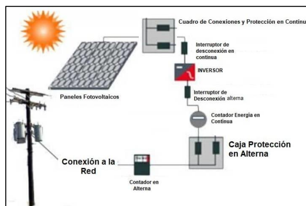
Fig. 19. Sistema Fotovoltaico Conectado a la Red completo Fuente: Recuperado de https://cutt.ly/ZNug0BD
