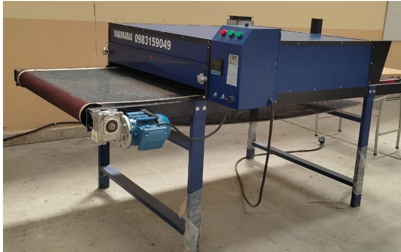
Figura 8. Túnel de secado de la Carrera de Textiles- UTN
