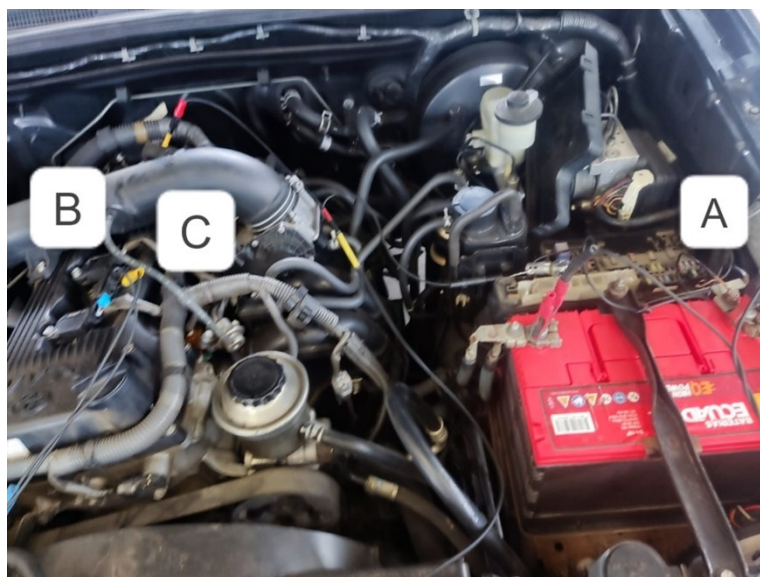
Figura 4.13. Conexión de accesorios para la obtención de señal IGT y corriente del módulo de la bobina de encendido del vehículo Toyota Hilux
