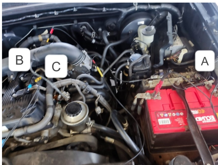
Figura 4.15. Conexión de accesorios para la obtención de la señal IGT y señal IGF del vehículo Toyota Hilux
