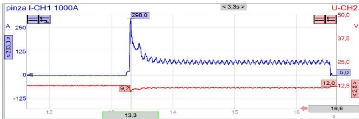
Figura 3.8. Oscilograma de caída de voltaje y consumo de corriente en prueba de Compresión Relativa
