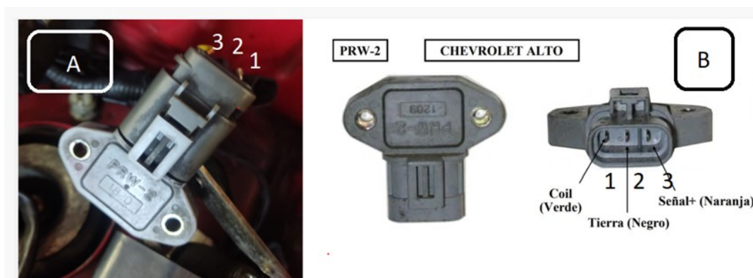
Figura 3.10. Información de cables de conexión de módulo de encendido
