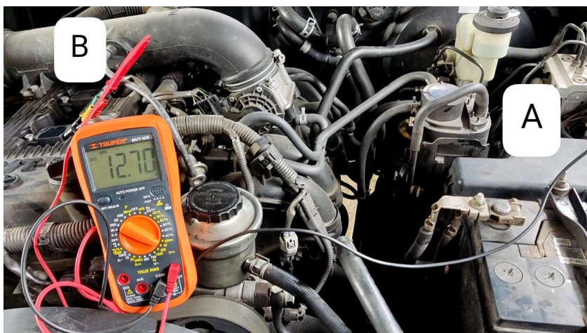
Figura 4.12. Verificación masa en módulo de bobina COP del vehículo Toyota Hilux
