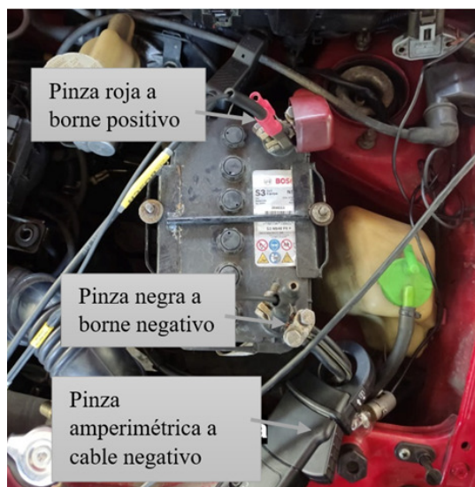
Figura 3.4. Conexión de Cables para pruebas
