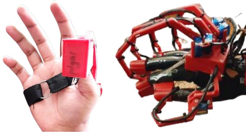
Figura. 71 Sujeción del exoesqueleto
