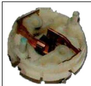
Figura 7 Escobillas de un motor de corriente directa Fuente:(Mecafenix, 2017)
