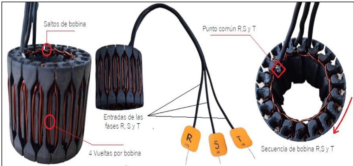
Figura 68 Entradas, saltos, configuración y secuencia de las bobinas y fases R, S y T. Fuente: Autor
