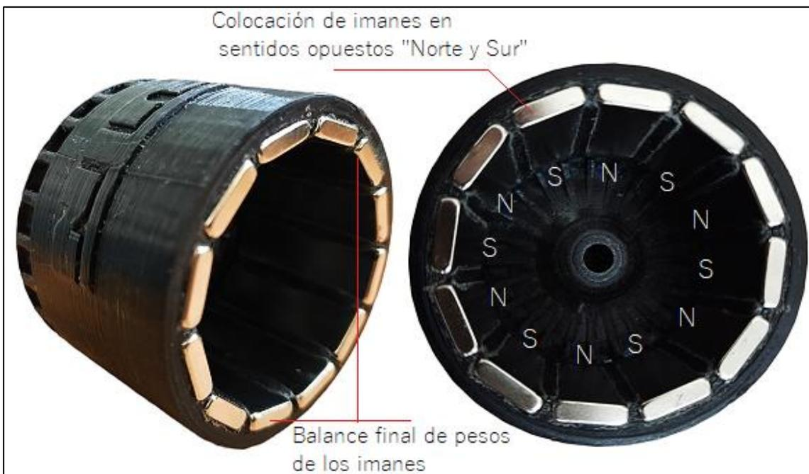
Figura 66 Ensamblaje y calibración de los imanes en el estator. Fuente: Autor
