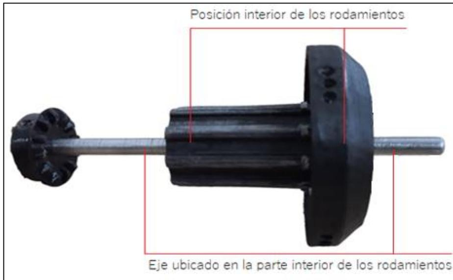
Figura 70 Ensamble de los rodamientos y eje en el armazón del estator. Fuente: Autor
