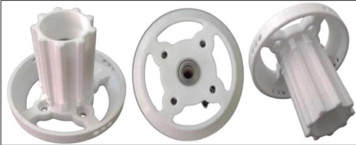
Figura 63 Diferentes vistas del armazón del estator impreso PLA Fibra de Carbono Proto-Pasta. Fuente: Autor
