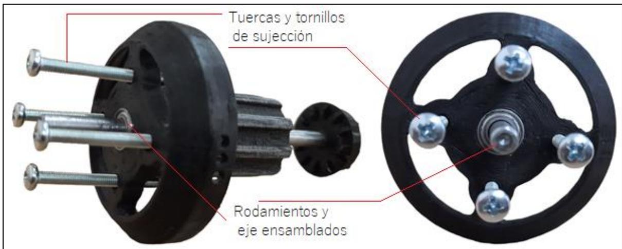
Figura 71 Colocación de tuercas y tornillos de sujeción. Fuente: Autor
