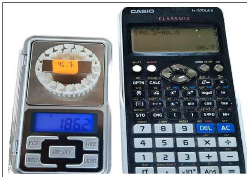
Figura 64 Designación de pesos de los imanes en la balanza analítica. Fuente: Autor
