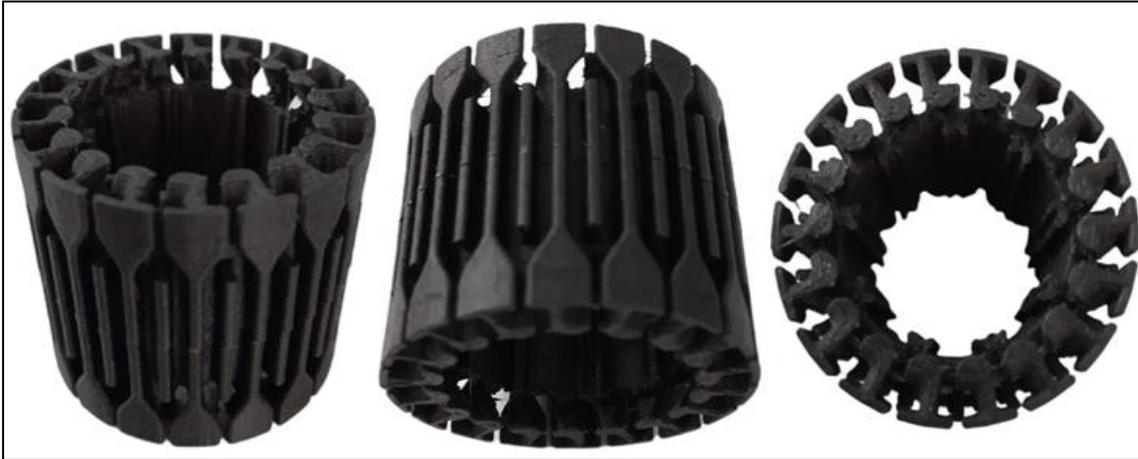
Figura 59 Diferentes vistas del rotor impreso en PLA Ferro-Magnético. Fuente: Autor
