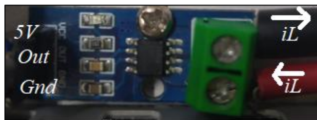
Fig. 40. Montaje de sensor de corriente ACS712.
