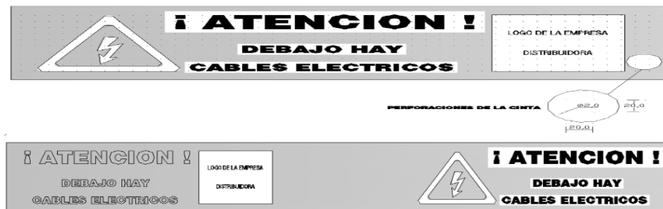
Figura 10. Muestra de la cinta para señalizar la existencia de cables eléctricos.
