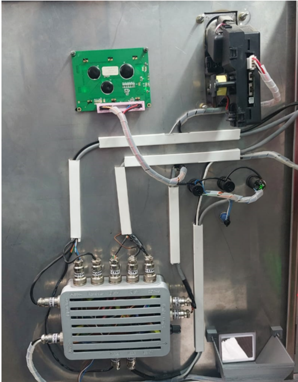
Figura 49 Distribución de conexiones. Fuente: Autor.
