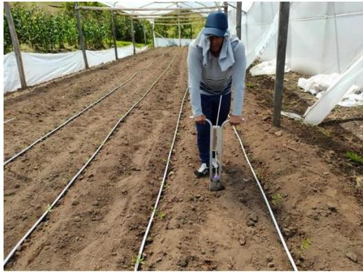
**Fotografía 5.** Toma de datos de infiltración del suelo
