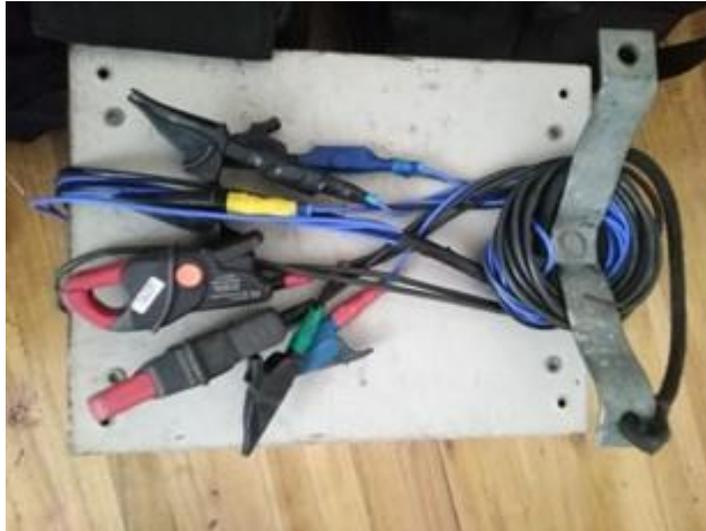
Fig. 2. 7: Pinzas Amperimétricas y Pinzas de Voltaje.
