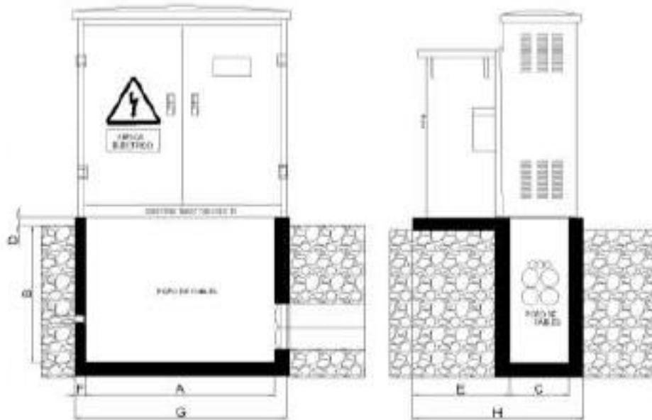
Fig. 3. 5: Cámara eléctricas a nivel.
