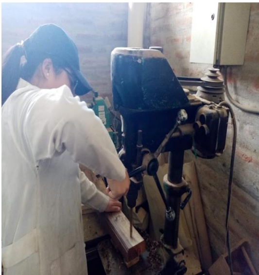
Figura 62. Ensayo de taladrado
