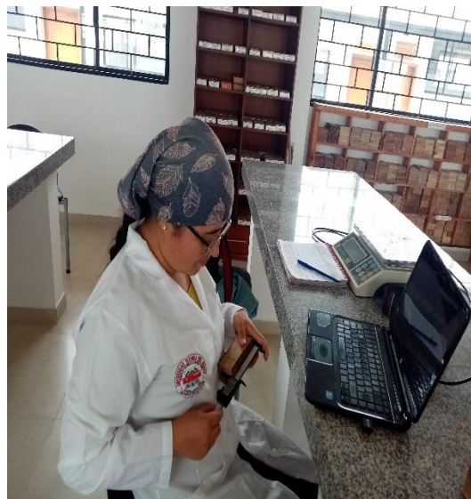
Figura 53. Codificación y medición de probetas
