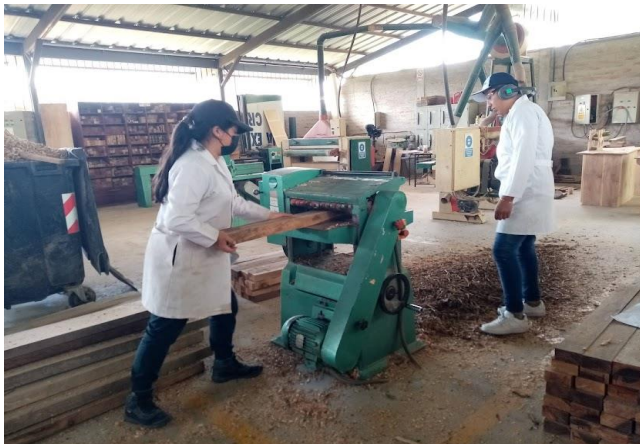
Figura 12. Proceso de cepillado
