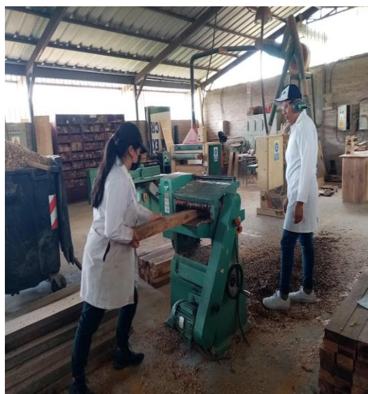
Figura 59. Ensayo de cepillado
