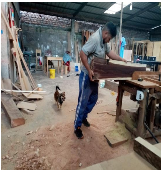
Figura 52. Preparación y escuadrado de las probetas
