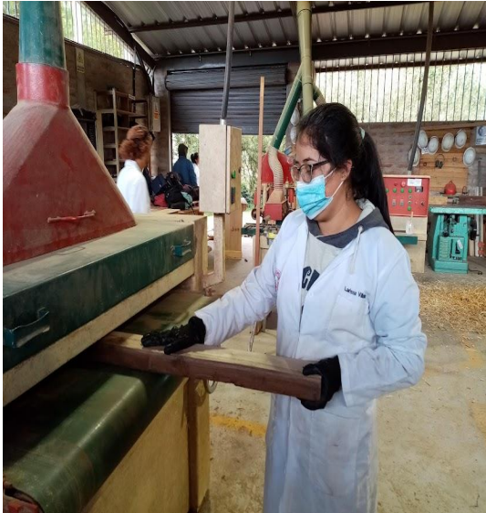
Figura 60. Ensayo de lijado
