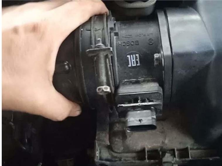
*Figura 12 Sensor MAF desconectado*
