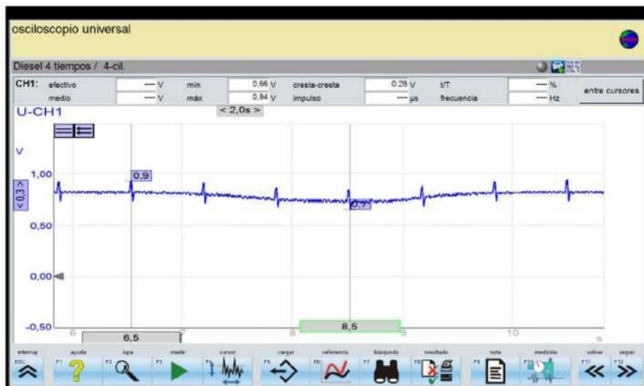
*Figura 3.15 Oscilograma del sensor de oxígeno post catalizador*
