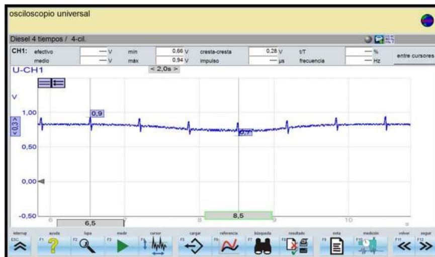
**Figura 3.10** Oscilograma sensor post catalizador a 2500 rpm
