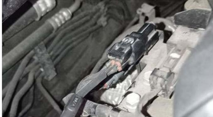
*Figura 2.10 Conexión del osciloscopio al socket del sensor de oxígeno*
