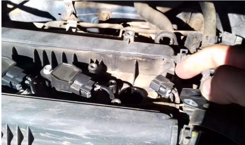
*Figura 10 Desconexión de bobina de encendido*
