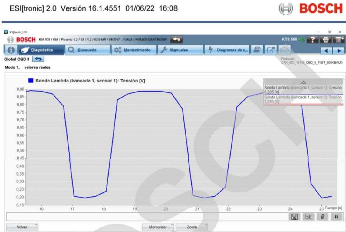
*Figura 9* Curva característica del sensor de oxígeno
