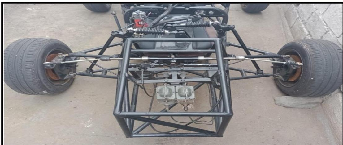
**Figura 3.43** Montaje de la caja de dirección en el bastidor del vehículo
