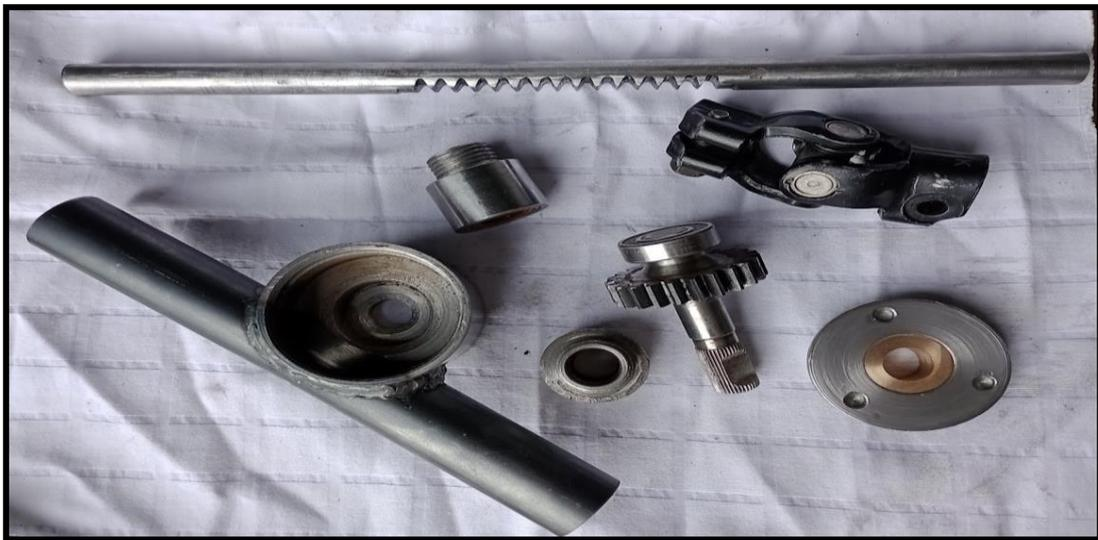
**Figura 3.39** Elementos que componen la caja de dirección para vehículos monoplaza
