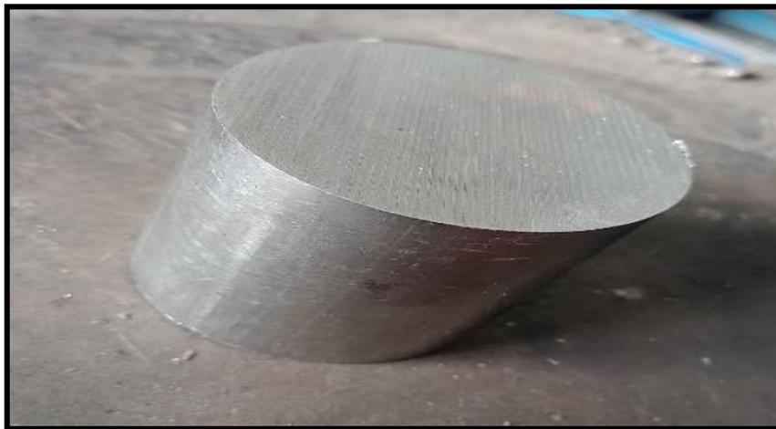
**Figura 3.30** Barra de Acero AISI 4140
