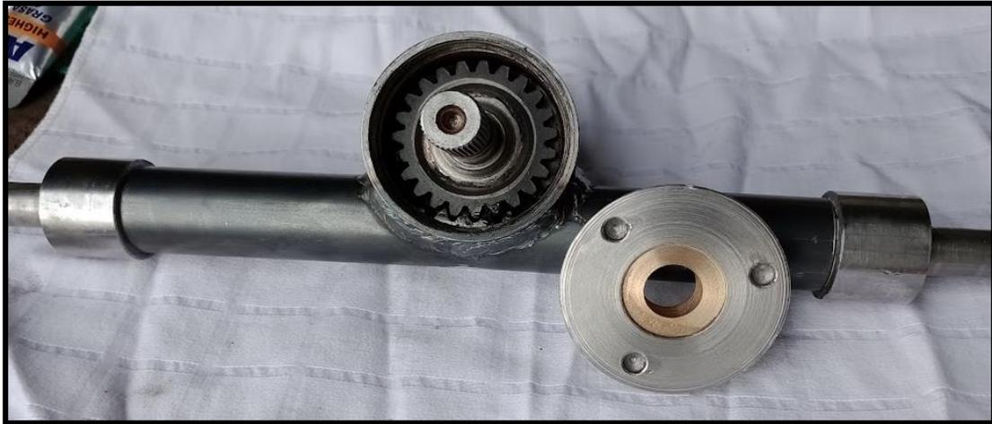
**Figura 3.42** Ensamble completo de la caja de dirección
