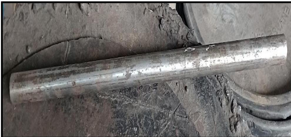
**Figura 3.32** Barra de Acero AISI 1020
