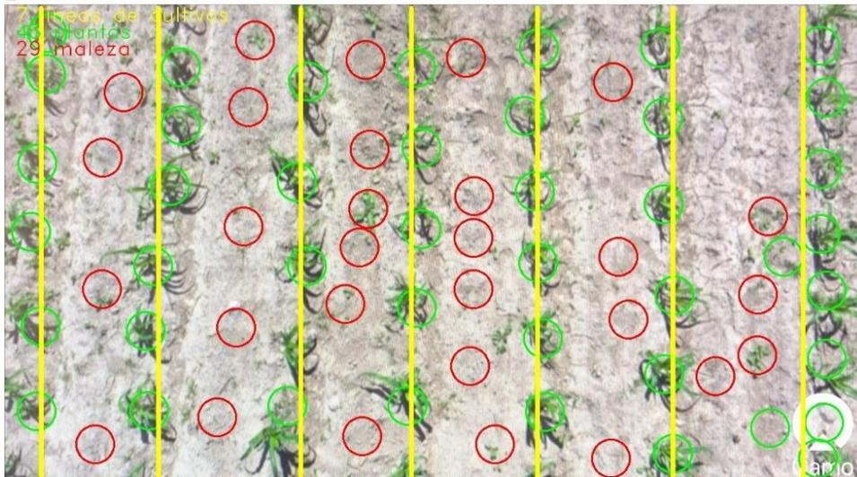
**Resultados:** La eficiencia en la precisión y conteo en la detección de líneas de cultivo y malezas es más del 95%, los resultados coinciden con lo visto por el ojo humano y el proceso por parte del algoritmo no dura más de 3 a 4 s en la PC con mejores prestaciones.
