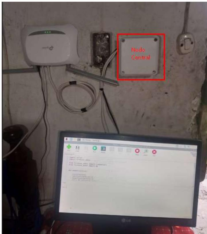
La segunda parte del nodo corresponde al circuito receptor LoRa, el cual fue ubicado en la parte alta junto a la vivienda a 3.50 m aproximadamente con la finalidad de conseguir línea de vista a todos los puntos del área de prueba y poder establecer comunicación entre los nodos móviles y el nodo central. Como se muestra en la Figura 47.
