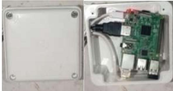
La segunda parte consta del circuito receptor LoRa como se muestra en la Figura 44. El cual es implementado de igual manera en un case protector y posteriormente ubicado en una parte alta, ya que eso permite que haya línea de vista con los nodos móviles y así poder establecer la comunicación.
