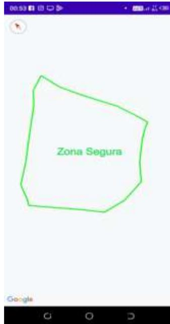
El nodo móvil se encuentra colocado sobre el bovino empieza a capturar datos sobre latitud y longitud para obtener la ubicación, estos datos son enviados a través de la comunicación LoRa y receptados por el Gateway. En la Figura 50 se puede observar como los datos pueden ser apreciados de manera local en la pantalla del nodo central.
