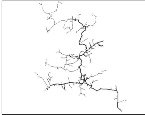
Fig. 58. Simulación de cálculo de flujo de carga en la red del alimentador Alpachaca para el escenario 2.
