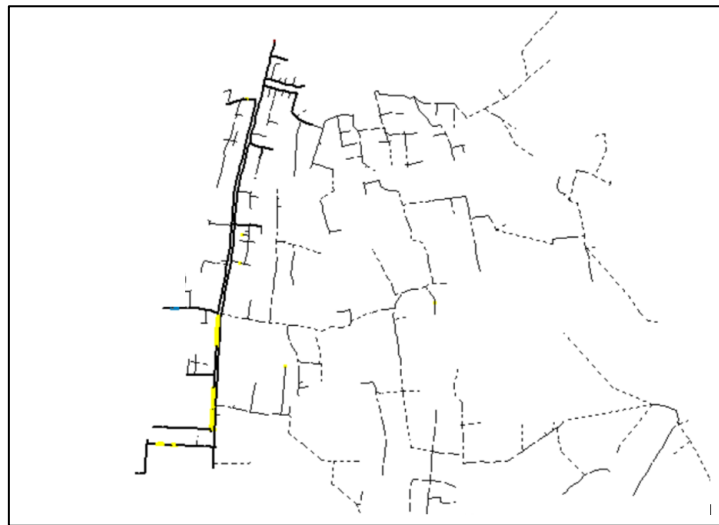
Fig. 53 Simulación de cálculo de flujo de carga en la red del alimentador El Retorno para el escenario 3.
