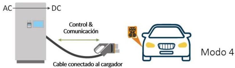
Fig. 15. Componentes modo de carga 4. Fuente: (TUVATIO, 2022).
