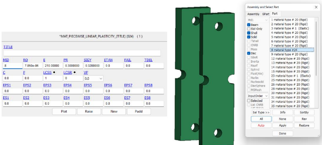
Figura 2.21 Modelo del material *MAT_PIECEWISE_LINEAR_PLASTICITY: Ligamento de la rodilla (PID 8)
