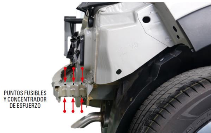
Figura 1.14 Carrocerías inteligentes - deformación programada (Autocrash, 2020)
