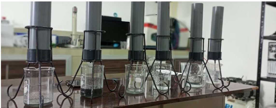
Nota. En la imagen se puede apreciar los filtros de cada diseño al inicio de las pruebas de flujo, siendo los tres primeros del diseño A y los tres siguientes del diseño B.
