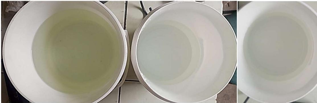
*Nota.* La imagen muestra los cambios de color en el agua antes de ser filtrada, luego de ser filtrada a través del diseño A y luego de haber sido filtrada a través del filtro del diseño B.
