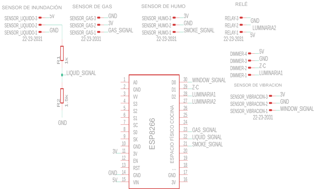
Fig. 36 Diseño placa electrónica cocina Fuente: (Autor,2023)
