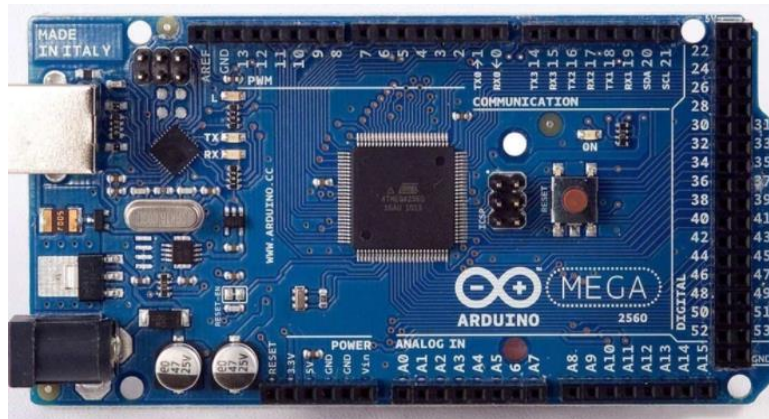
Fig. 1.13 Placa Arduino Fuente: (ARDUINO, 2018)
