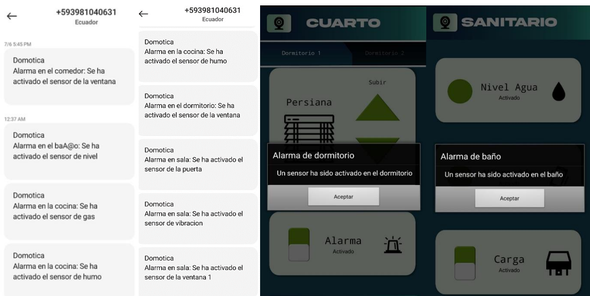
Fig. 82 Prueba de funcionamiento sistema de seguridad Fuente: (Autor,2023)
