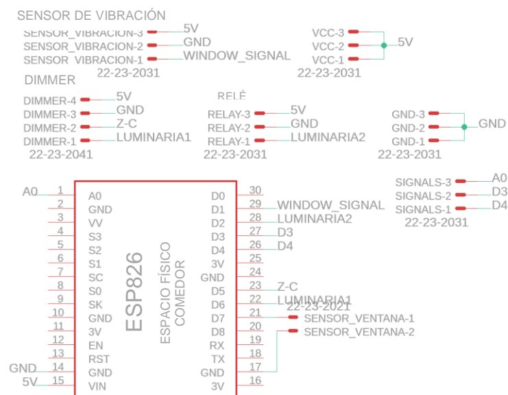
Fig. 45 Diseño placa electrónica comedor Fuente: (Autor,2023)
