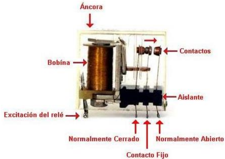
Fig. 1.9 Relé electromagnético Fuente: (Maldonado & Chacha, 2017)
