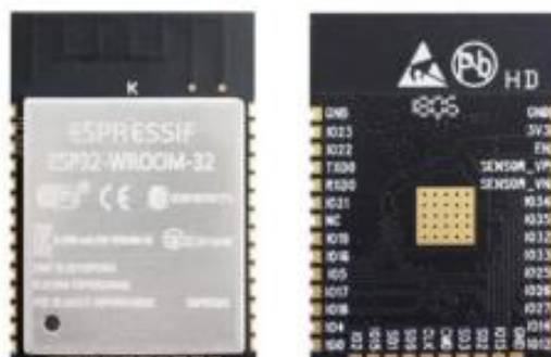
Fig. 1.14 Módulo ESP32 Fuente: (Herranz, 2019)
