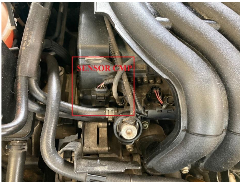
Figura 2.7. Sensor CMP en vehículo Volkswagen Jetta 2008
