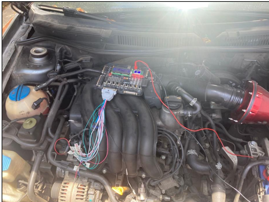
Figura 2.27. Uso de banco de pruebas Jaky47 para simulación de señal CKP y CMP
