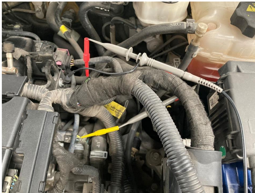
Figura 2.23. Conexión de las sondas de medición a los sensores CMP del Chevrolet Cruze
