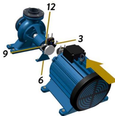
Figura 2.16. *Método del reloj para alineación de ejes y generadores [49]*
