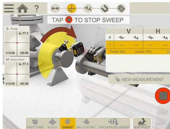
Figura 2.19. Simulación del uso del método barrido continuo por Easy Laser [49]
