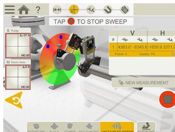
Figura 2.20. Simulación del uso del método barrido desacoplado por Easy Laser [49].
