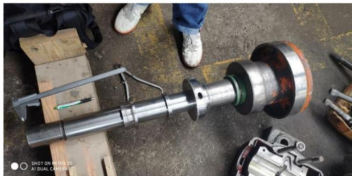
Figura 2.7. Eje del grupo N°2 de la central hidroeléctrica Hidrocarolina en mantenimiento
