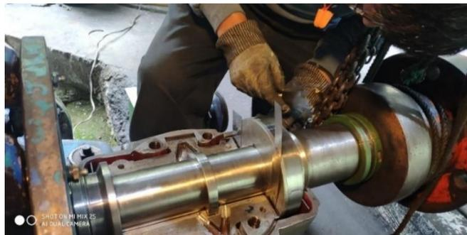
Figura 2.10. Verificación medida de separación entre cojinete axial y cojinete guía
