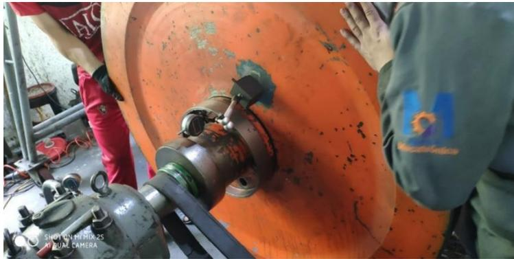
*Figura 4.44. Técnica de alineación con la ayuda de reloj palpador*
