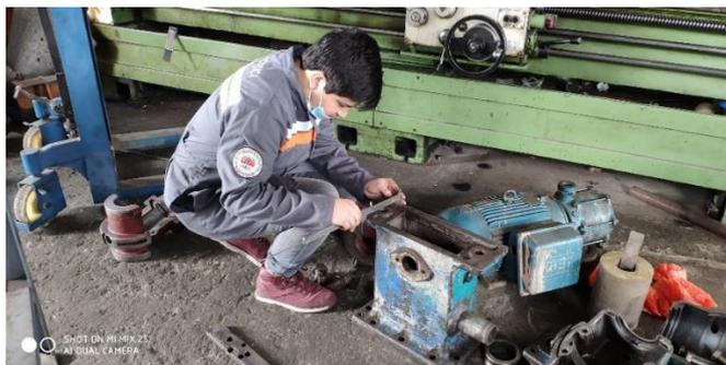
*Figura 4.3. Mediciones realizadas en taller de las piezas de la turbina grupo N°2 de la central hidroeléctrica Hidrocarolina.*
