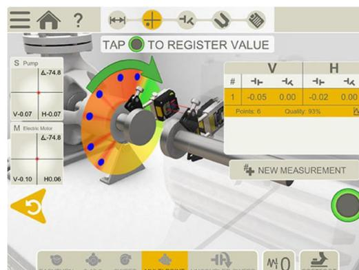
Figura 2.18. Simulación del uso del método multipunto por Easy Laser [49].
