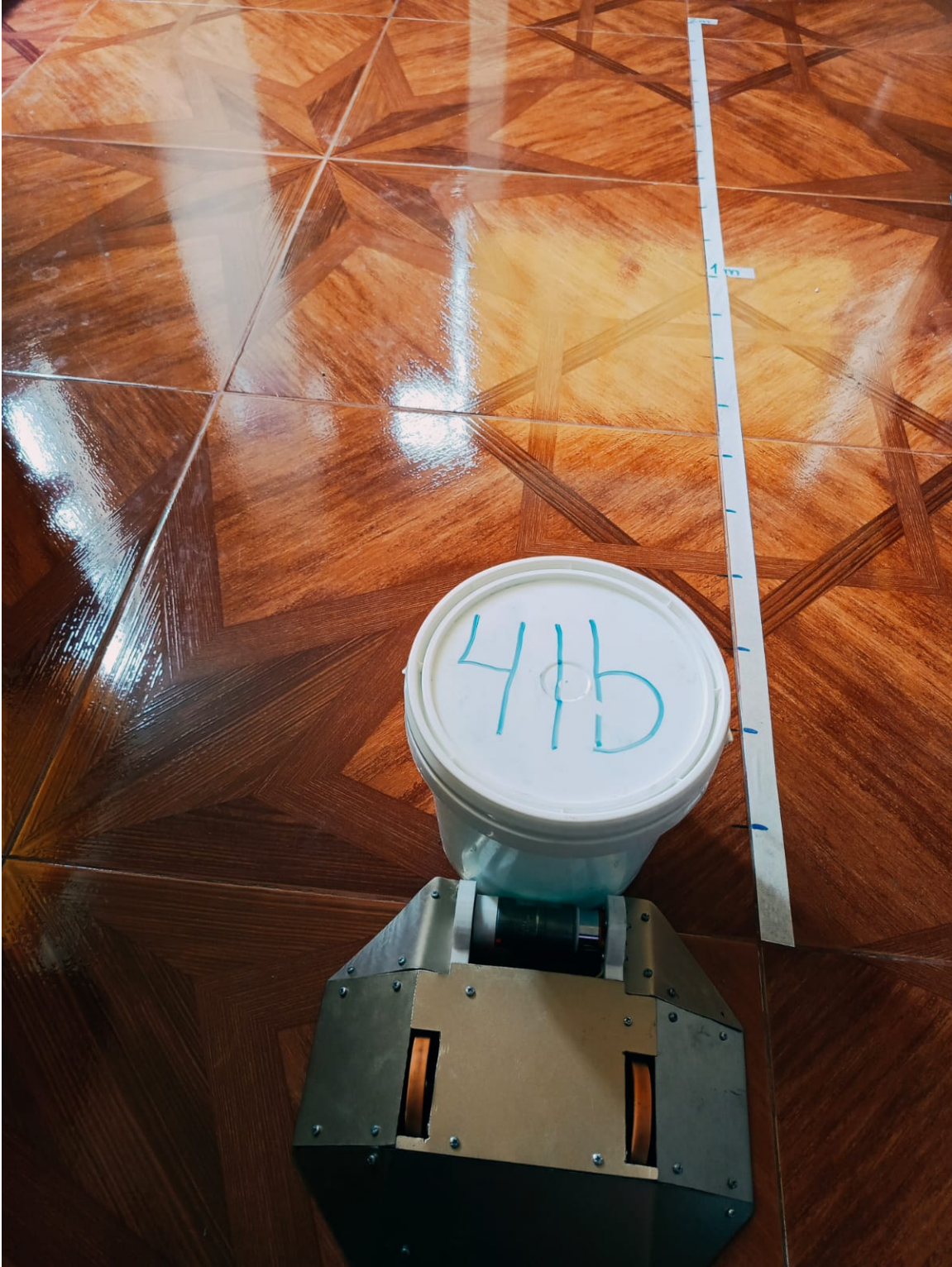
Prueba de la velocidad y rendimiento del robot con un obstáculo de 4lb.
