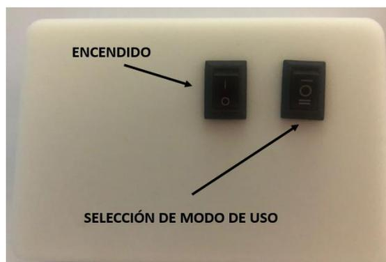
Se realiza la selección del modo de uso con el botón como muestra la Figura 5.2, puede funcionar en modo manual o en modo automático.
