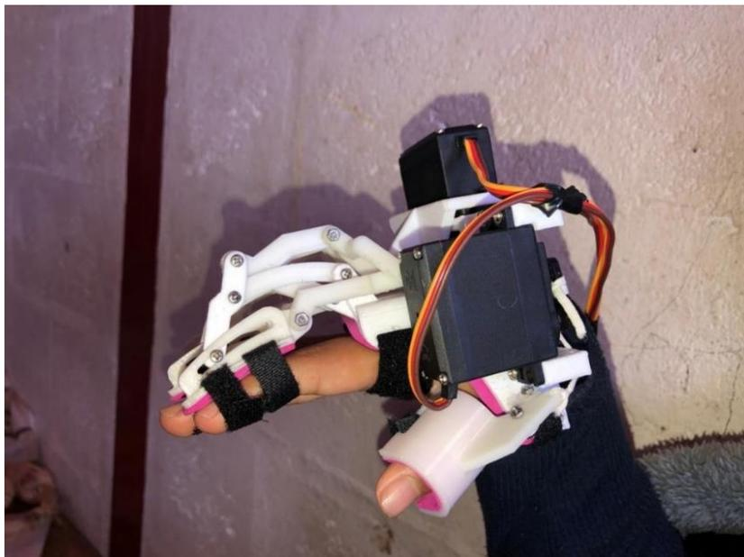
El dispositivo de la mano, el subsistema del dedo pulgar cumple con las especificaciones establecidas en los requerimientos al realizar los movimientos de flexión y extensión de manera natural.
