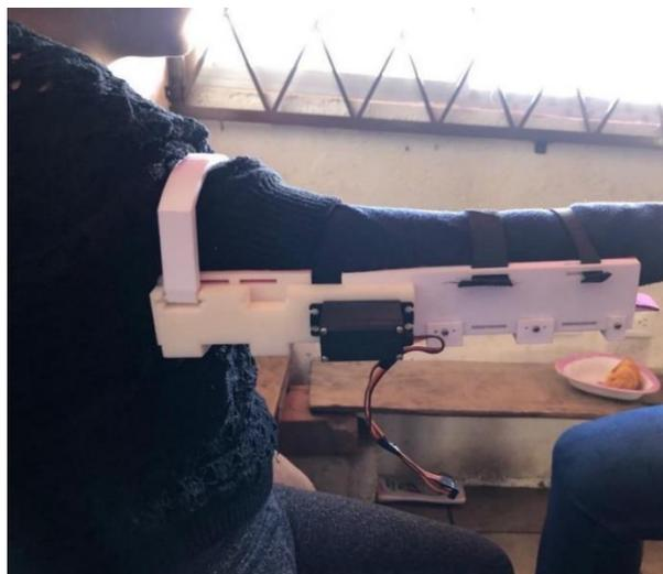
Cuando se realiza el movimiento de la flexión se puede observar en la Figura 4.44, que la muñeca no tiene tanta curvatura como cuando lo realiza sin el exoesqueleto, se encuentra un movimiento más natural gracias a que el movimiento de flexión es guiado por el exoesqueleto.
