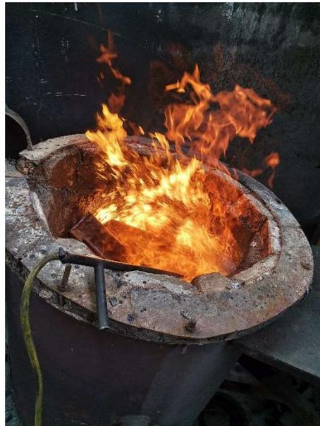
*Figura 32: Fundición de aluminio en horno tipo Venturi a temperatura superior a 600 grados*
