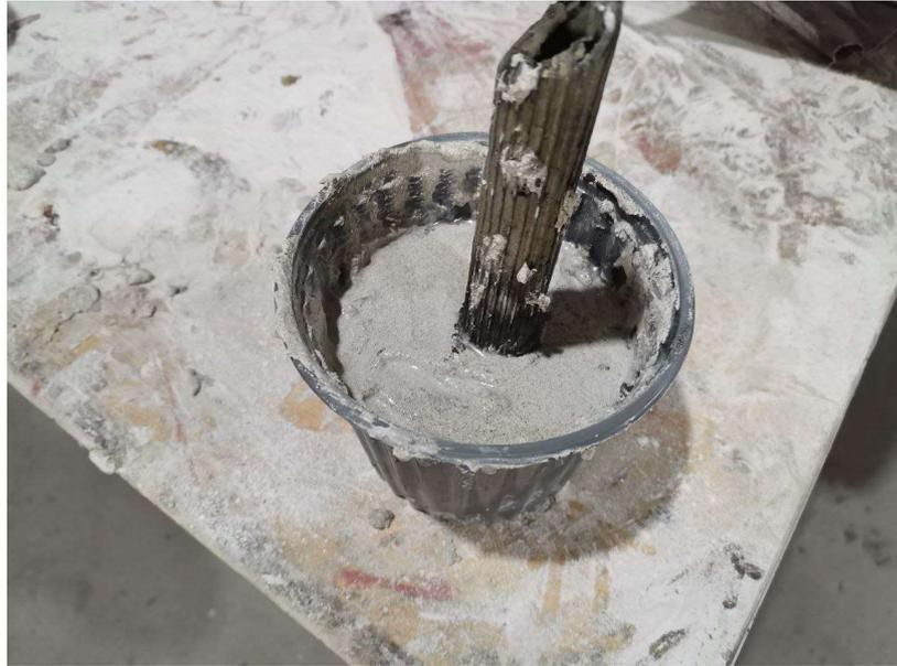
*Figura 12: Prueba realizada con el 20% de humedad*
