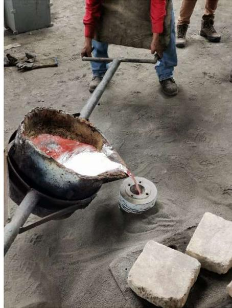
*Figura 35: Vaciado de aluminio fundido en molde*
