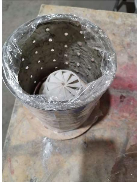
*Figura 16: Estructura de molde con pieza en interior*
