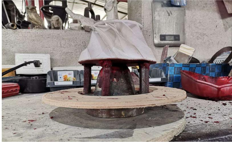
*Figura 17: Vaciaderos y respiros realizados con parafina de moldeo*
