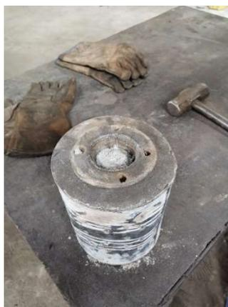
*Figura 36: Herramientas utilizadas para extracción de pieza de molde*
