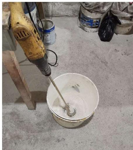
*Figura 20: Mezclador utilizado para elaborar material de molde*
