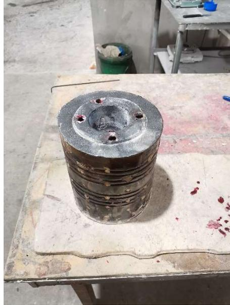
*Figura 27: Molde curado salido del horno*
