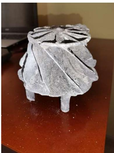
*Figura 48: Tercera prueba realizada de pieza fundida*
