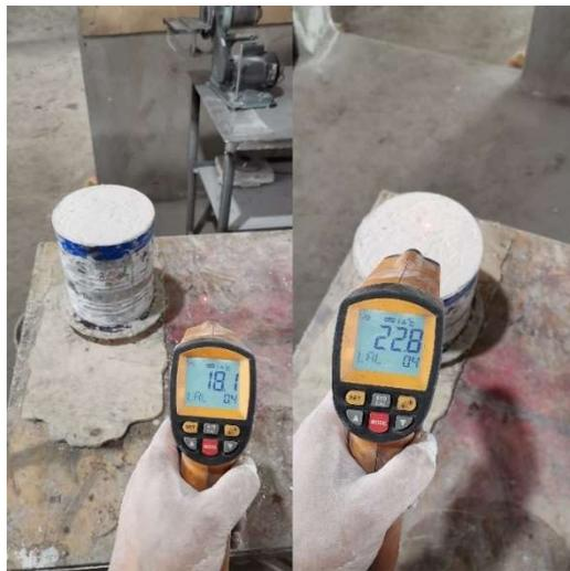
*Figura 24: Comparativa de temperatura de molde durante proceso de fraguado*
