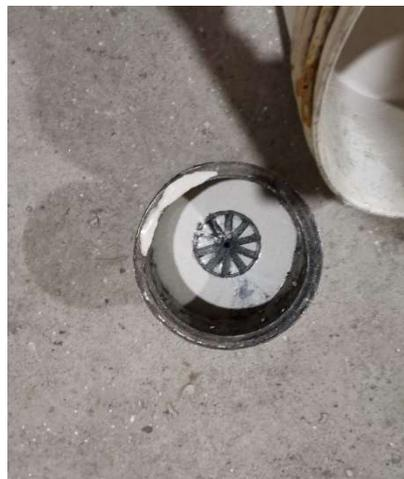
*Figura 22: Molde con pieza en interior y mezcla realizada*
