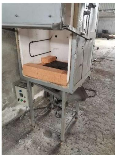
*Figura 26: Horno mufla utilizado para proceso de curado de molde*
