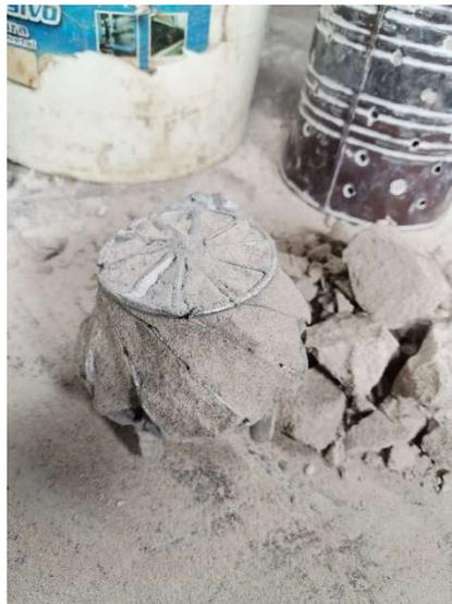
*Figura 38: Limpieza de pieza fundida*
