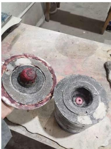
*Figura 25: Desmontaje de preforma de mazarota de molde*
