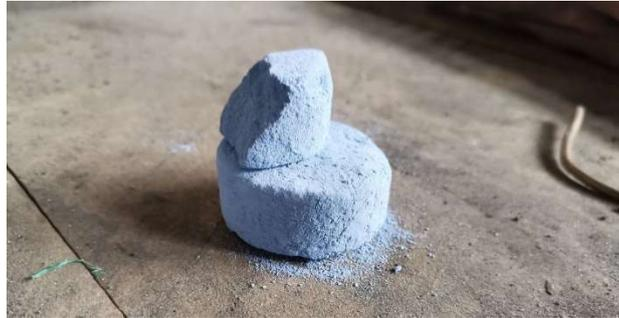
*Figura 31: Pastillas desgasificantes de aluminio activadas por cloro*
