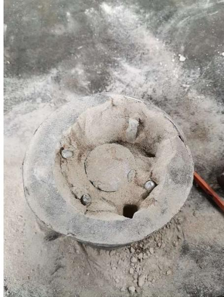
*Figura 37: Extracción de la pieza fundida de molde*
