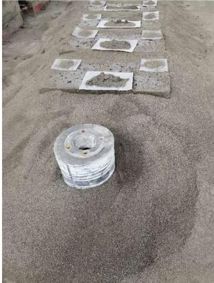
*Figura 33: Molde rodeado de arena verde para ejercer contrapresión en el molde*
