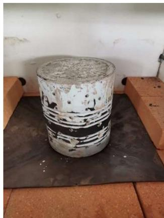
*Figura 28: Molde quemado en horno mufla*
