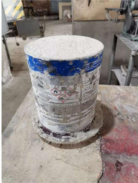
*Figura 23: Molde finalizado para empezar proceso de fraguado*
