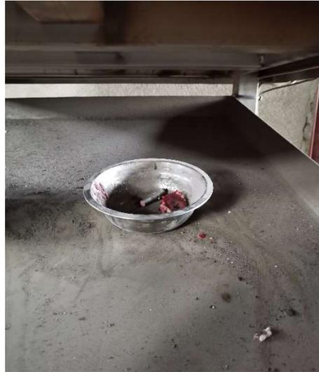
*Figura 29: Residuos de PLA luego de proceso de quemado*
