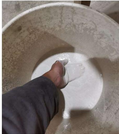
*Figura 21: Consistencia de material de molde elaborado*
