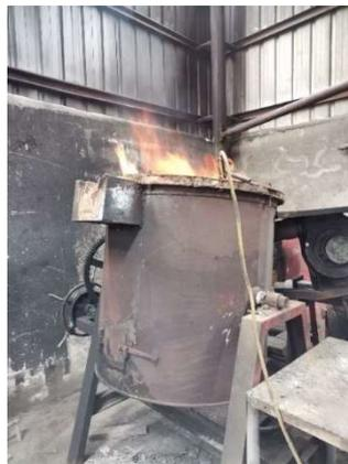
*Figura 30: Horno tipo Venturi para fundición de aluminio alimentado por GLP*
