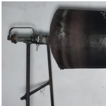
Figura 4.10. Centro del eje del tambor para el Ingreso de la termocupla tipo K.
