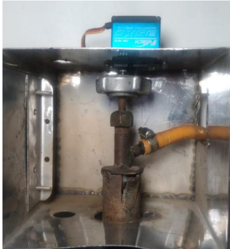
Figura 4.9. Base para acople del servomotor con válvula de gas.
