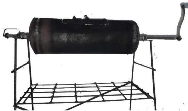
Figura 4.1. Máquina tostadora de café usada en este proyecto.
