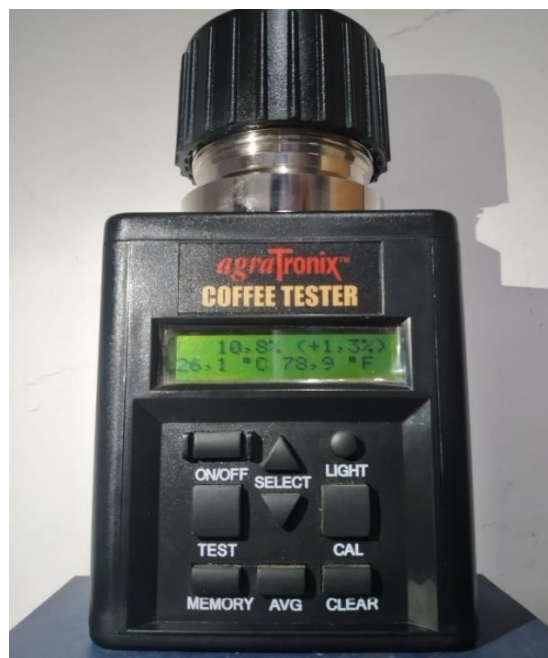
Figura 4.12. Dispositivo para la medición de la humedad del café.
