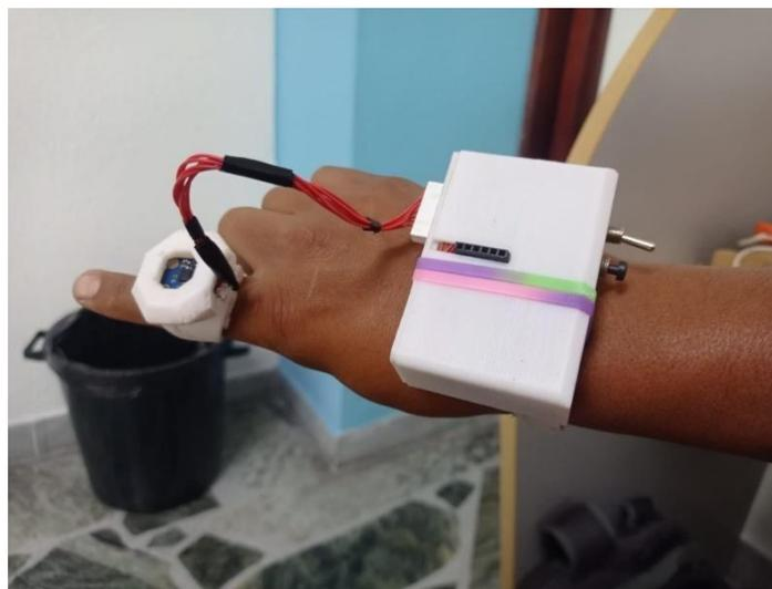
Para accionar la retroalimentación, el usuario debe realizar un movimiento de flexión (movimiento de fuerza) de la articulación metacarpofalángica, ángulos. El nivel de vibración emitida por el motor vibrador es directamente proporcional a la variación de velocidad y ángulo de flexión.
