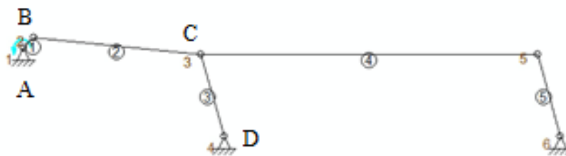
Figura 32. Mecanismo manivela oscilante para el sistema de acomodado.
