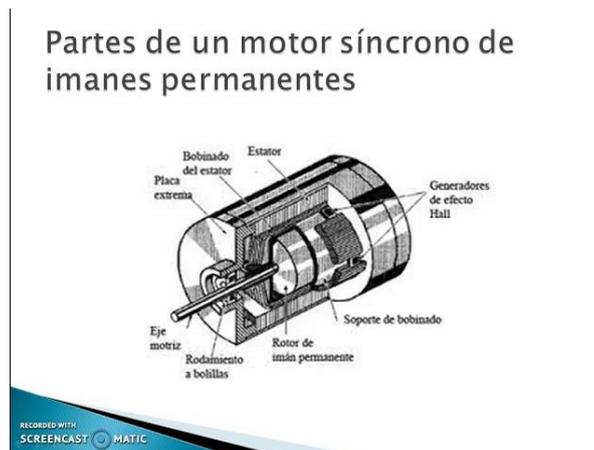
**Figura 1.5** Motor síncrono de imanes permanentes
