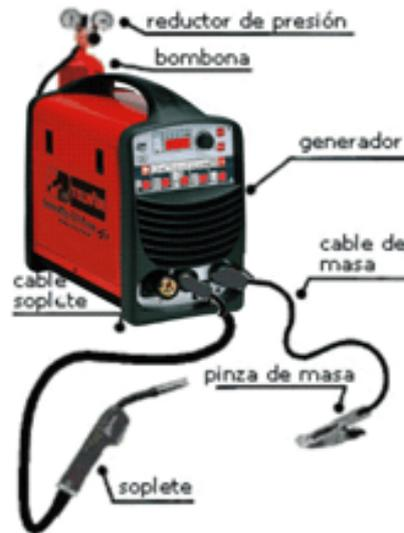
**Figura 1.8** Elementos de la suelda MIG/MAG
