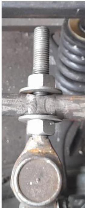
**Figura 2.28** Sistema de regulación de camber
