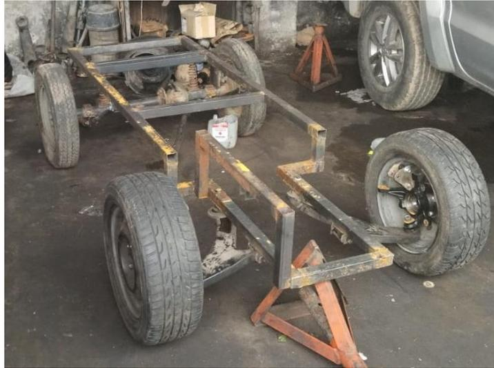
**Figura 2.23** Construcción chasis
