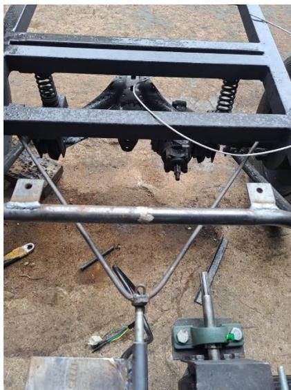
**Figura 2.34** Adaptación para frenos
