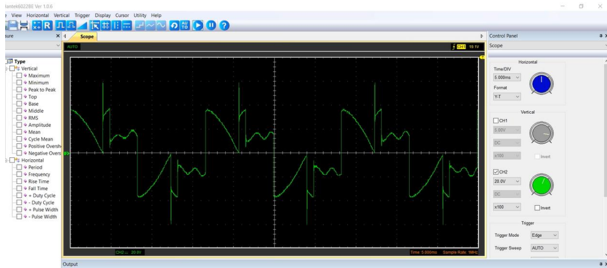
Fig 48. Fase S con carga (Motor-Generador) Fuente: Autor
