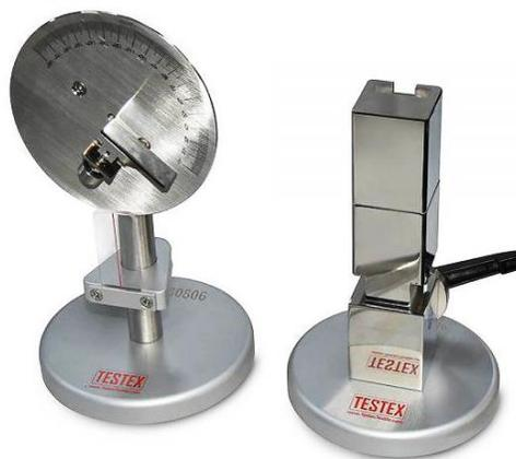
*Figura 11.* Dispositivos de carga y artículo de ángulos de recuperación de arrugas
