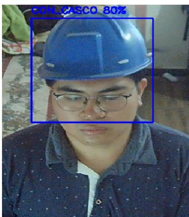
El sistema detecta correctamente cuando un trabajador esta dejando de usar el casco de seguridad como se muestra en la Figura 46.
