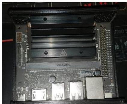
Luego de encajar la placa en la carcasa inferior se procede a colocar la carcasa superior haciendo una ligera presión hasta que se logre sujetar como se muestra en la Figura 43.
