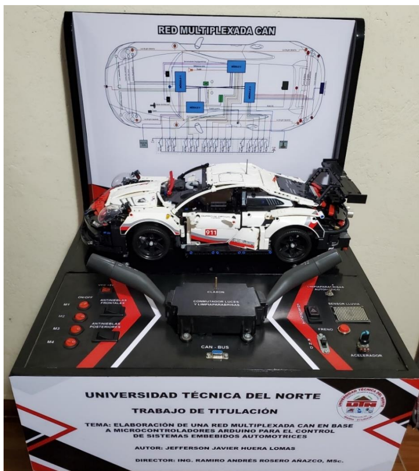
Figura 4.24 Prototipo de la red multiplexada CAN
