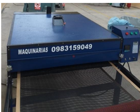
Túnel de Secado
