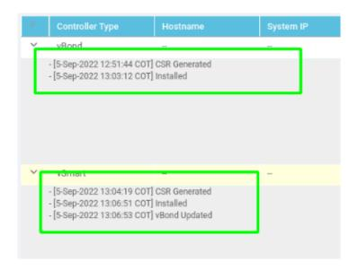
Dentro del dispositivo debe observarse que, se ha generado la solicitud de firma y está instalado correctamente.
