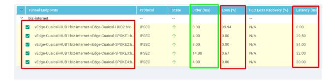
Por otro lado, en la Figura 103 se muestra los túneles establecidos mediante un enlace de transporte desde el HUB1 (biz-internet). En este caso, el equipo cuenta con 5 túneles generados; con lo cual, se evidencia que a medida que la red crece, el número de túneles a gestionar también crece de acuerdo con la Ec.2, ya que cada enlace de transporte formará sus propios túneles.
