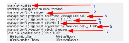
En la Figura 28 se muestran las configuraciones iniciales del sistema, y es importante destacar que el parámetro "organization-name" es crucial para la integración del dispositivo a la red superpuesta. Si los nombres no coinciden, el equipo no podrá ingresar ni establecer comunicación con los demás nodos. Para realizar estas configuraciones, se debe seguir los siguientes pasos:
