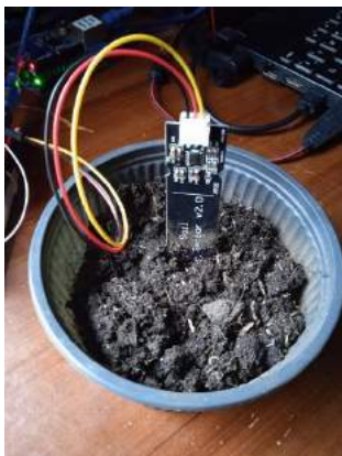
Figura 40. Lectura de humedad con suficiente agua
