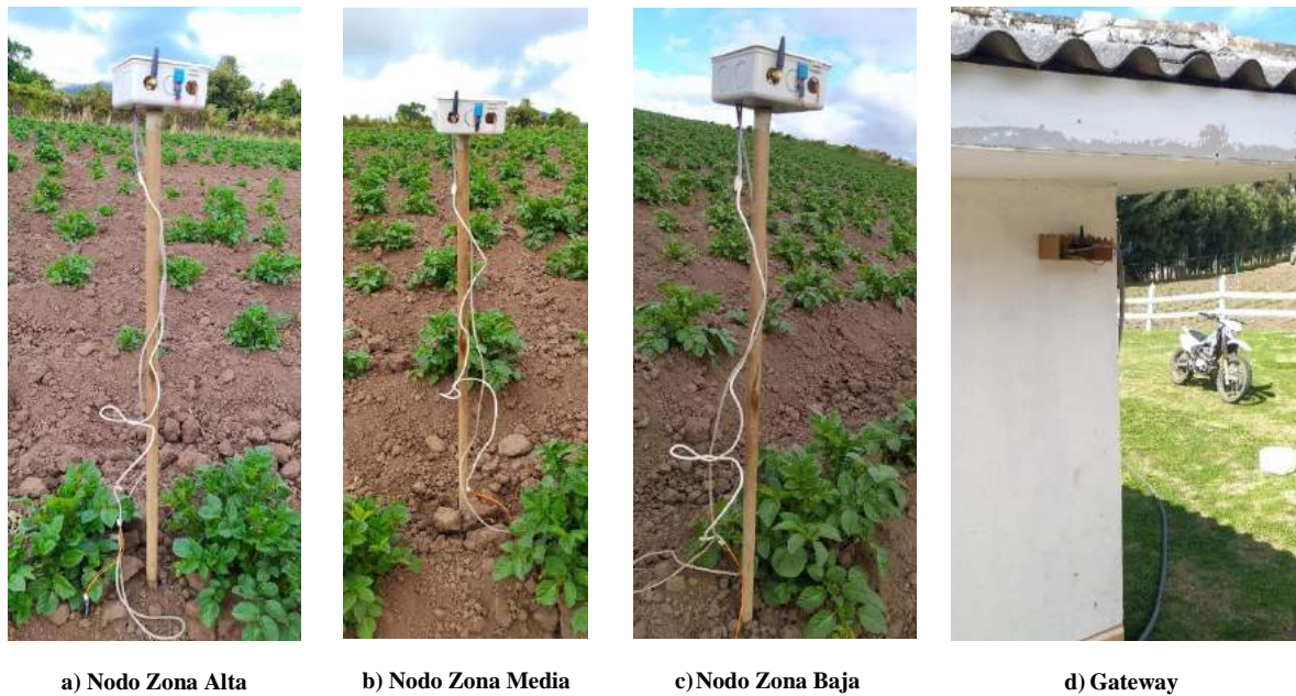
Figura 107. Implementación nodos sensores y gateway
