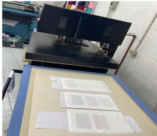
Se procede a ingresar la bandeja y se baja la plancha de sublimado, se espera 45 segundos y se extrae la bandeja, seguido del papel, obteniendo las muestras sublimadas.
