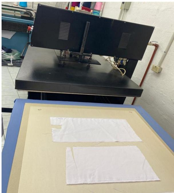
Como tercer paso, se procede a colocar las muestras sobre la bandeja de sublimado teniendo en cuenta los parámetros utilizados para las pruebas con los testigos de tela.
