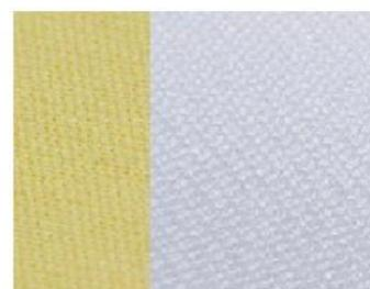
Punto perlé o perlado en el mismo una pasada forma malla en la fontura delantera y en la trasera hace malla cargada y en la pasada siguiente teje ligamento rib.
