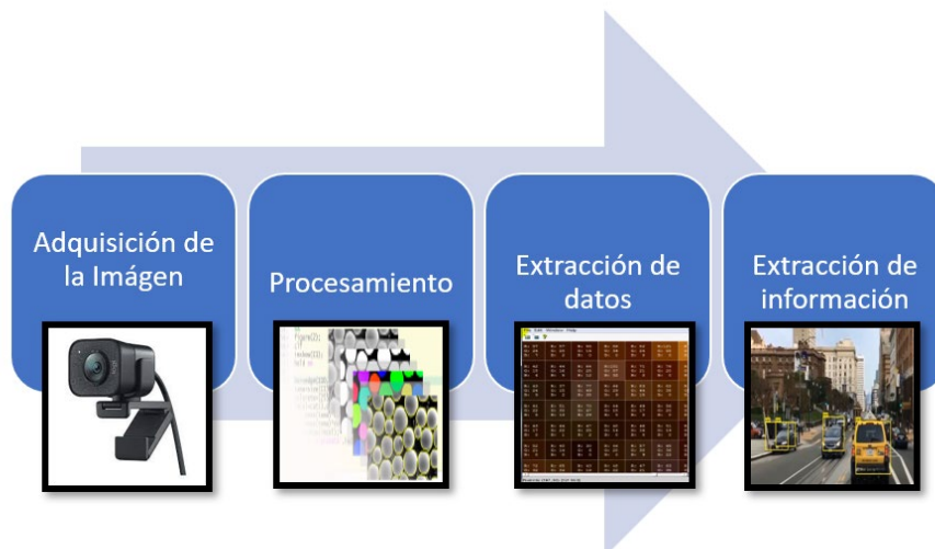
Figura 2.3. Proceso de visión artificial
