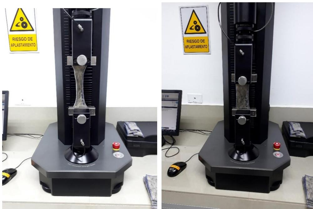
**Anexo 2.** Pruebas de resistencia a la tracción y elongación
