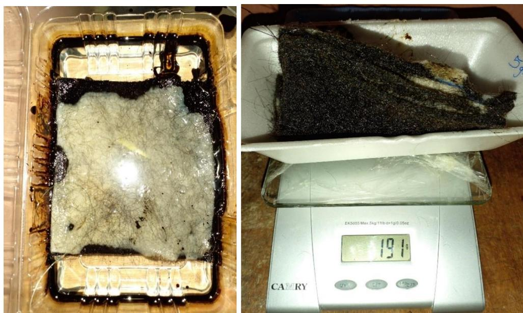
**Anexo 6.** Pruebas cortas de adsorción con muestras de triple capa laminar de no tejido
