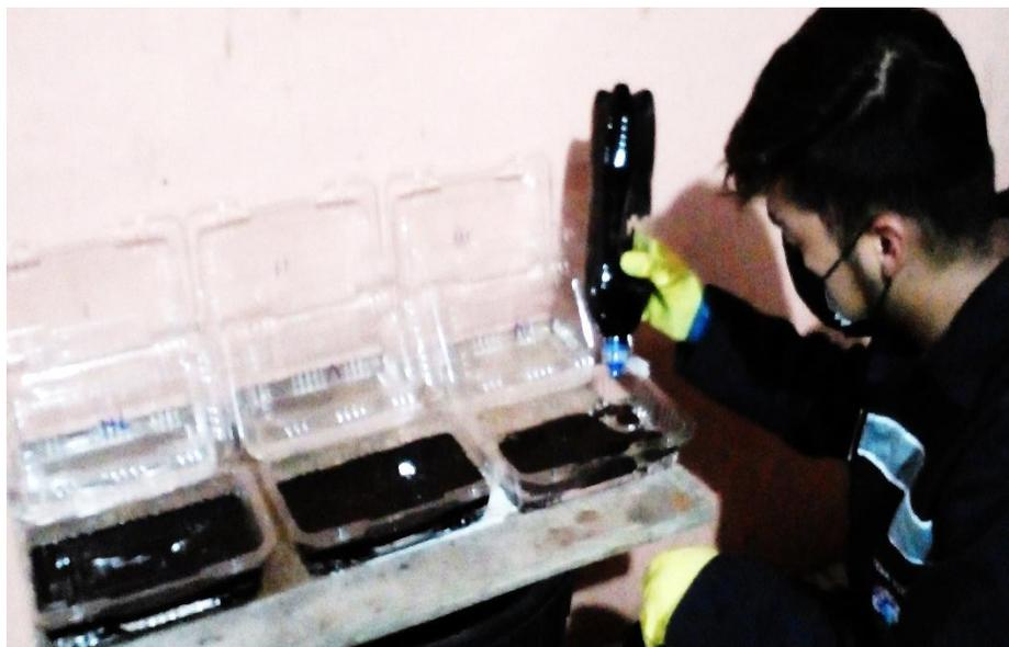
**Anexo 3.** Aplicación de capa de hidrocarburo sobre la superficie del agua empleada en las celdas de prueba
