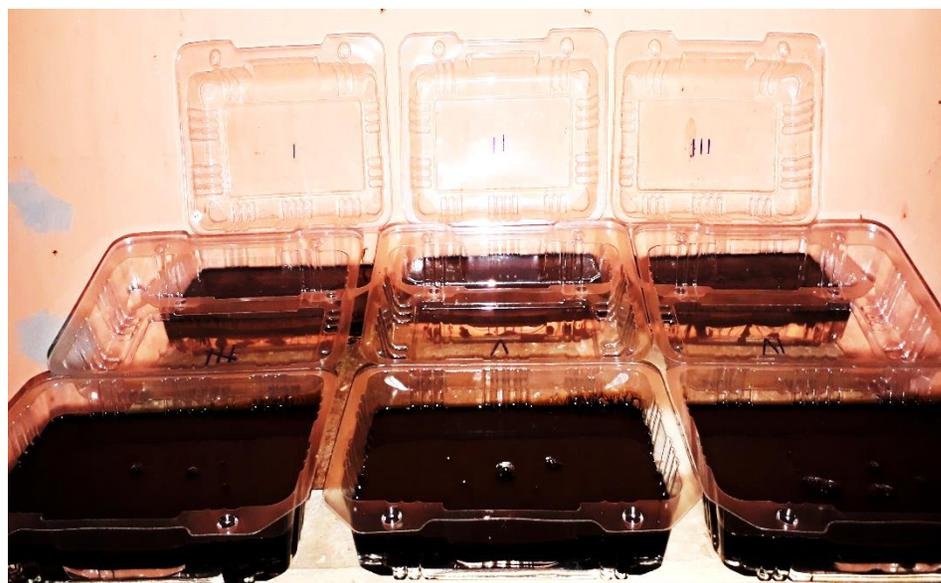
**Anexo 4.** Celdas de prueba previo a las pruebas de adsorción
