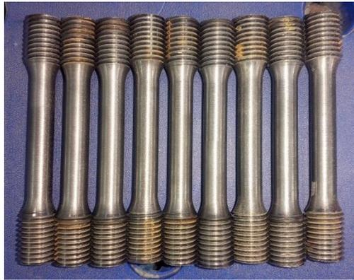
**Figura 3.16** Probetas de tracción mecanizadas bajo norma ASTM A48/A48M
