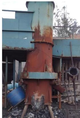
**Figura 2.9** Alto horno capacidad de 250 kg
