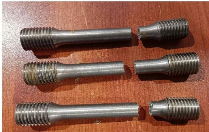
Fotografía 2. Muestras (Grupo P) después del ensayo de tracción.
