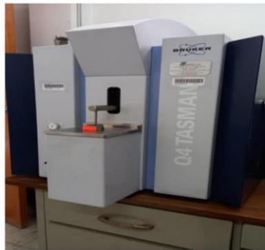
**Figura 2.30** Espectrómetro de Chispa marca BRUKER modelo Q4TASMAN
