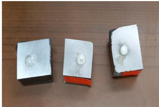
**Figura 3.17** Probetas para ensayos metalúrgicos bajo norma ASTM E3-95
