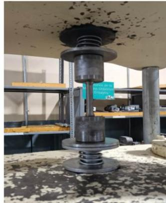
**Figura 2.31** Montaje de la muestra M23.054.01 en la maquina universal de ensayos
