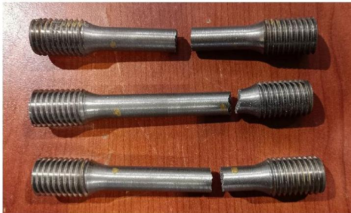
Fotografía 6. Muestras (Grupo 0.5) después del ensayo de tracción.
