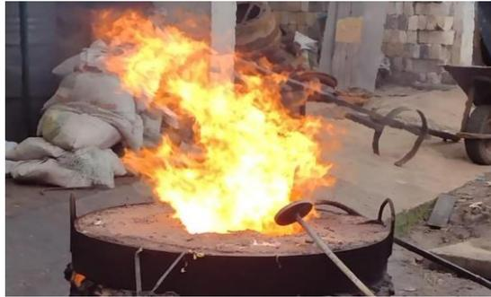
**Figura 3.12** Secado mediante quemador con gas licuado de petróleo (GLP)
