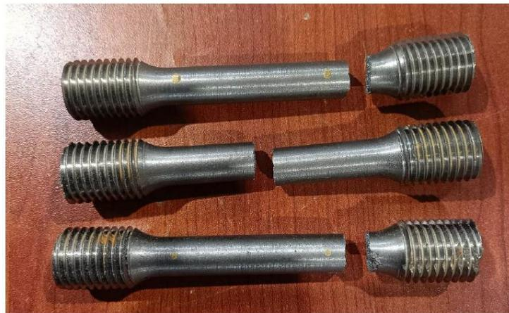
Fotografía 4. Muestras (Grupo 1) después del ensayo de tracción.
