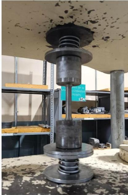
Fotografía 5. Montaje de la muestra M23.054.07 en la máquina universal de ensayos.
