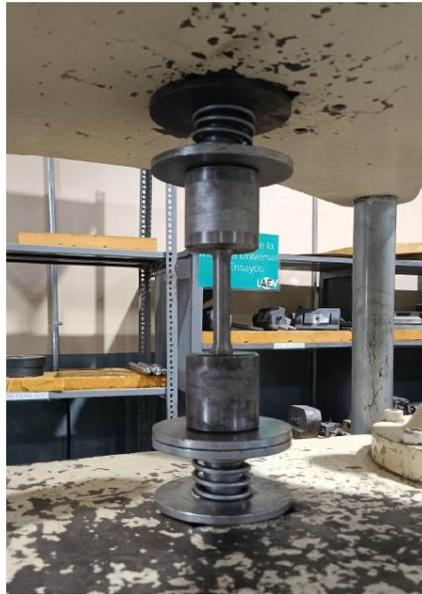
Fotografía 3. Montaje de la muestra M23.054.04 en la máquina universal de ensayos.
