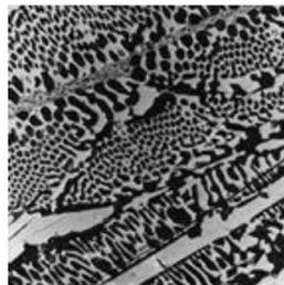
**Figura 2.6** Microestructura de la fundición blanca
