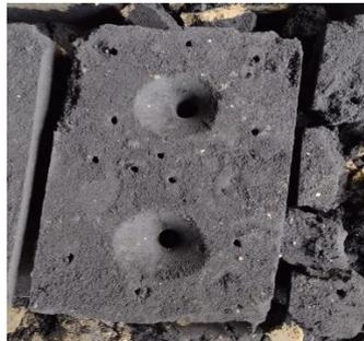
**Figura 2.12** Molde de las muestras fundidas
