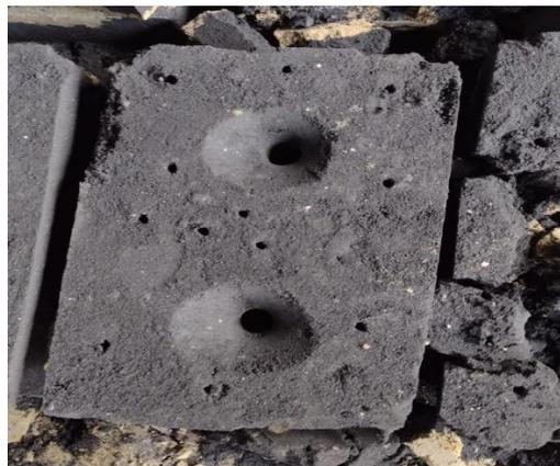
**Figura 3.11** Orificios de liberación de presión (pequeños), orificios para verter el material fundido (grandes)
