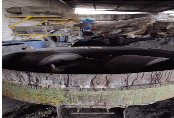
**Figura 3.10** Triturador de rodillos
