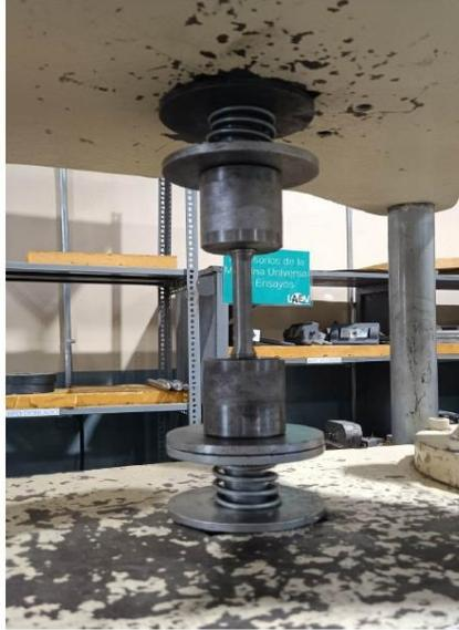
Fotografía 1. Montaje de la muestra M23.054.01 en la máquina universal de ensayos.
