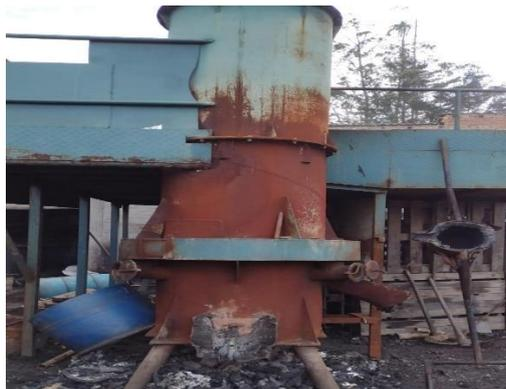
**Figura 3.13** Alto horno de fundición continua
