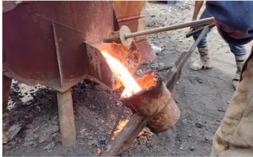
**Figura 3.14** Fundición de MWNTC's con ASTM A48 clase 20
