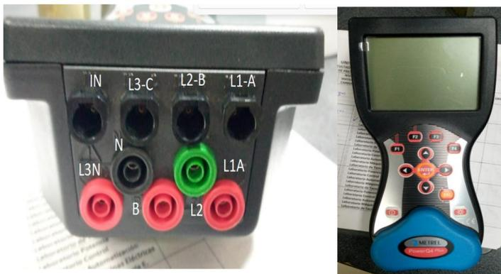
*Nota.* Entradas de conexión del equipo de medición Metrel PowerQ4 Plus.
