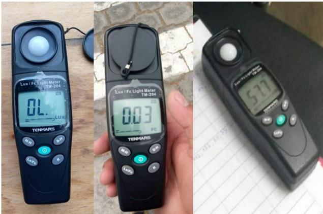
*Nota.* Equipo de medición de LUX Light Meter TM-204
