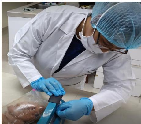
**Almacenamiento.** Por último, se procedió a almacenar los envases en dos refrigeradores con temperaturas de enfriamiento de 6 y 12°C respectivamente (figura 8). Se emplearon dos controladores de temperatura para asegurar que el chorizo se mantuviera a la misma temperatura al momento de realizar los análisis después de 12 días de almacenamiento.
