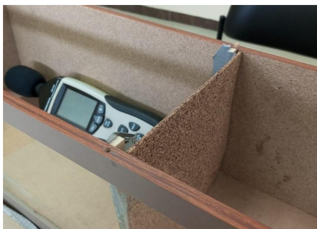
Figura 2.16. Material colocado para evaluar reverberación.
