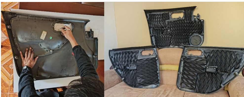
Figura 2.44. Aplicación de material plegado a las puertas.
