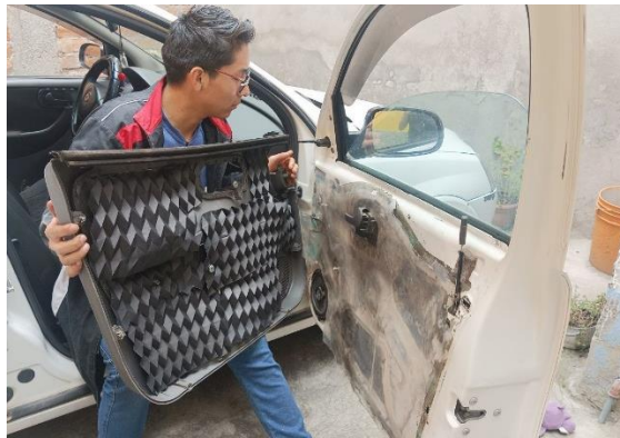
Figura 2.45. Reinstalación de paneles de puertas.
