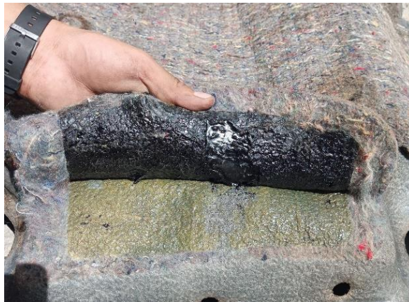
Figura 2.37. Desprendimiento de insonorización estándar.
