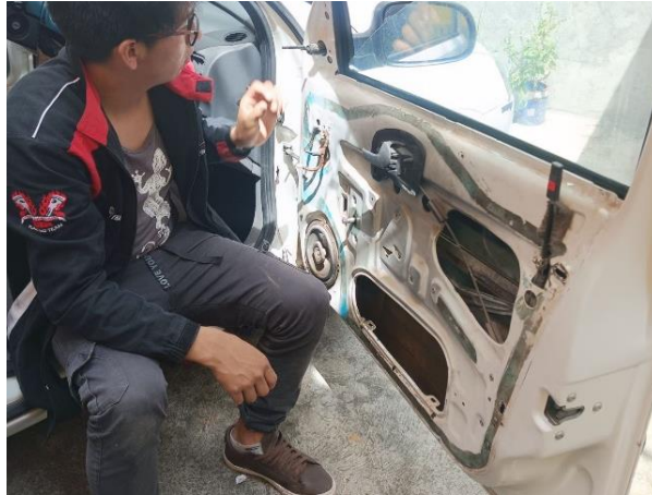
Figura 2.43. Desarmado de paneles de puerta.
