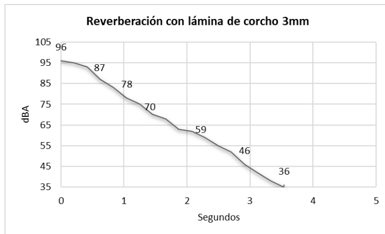
Figura 2.22. Reverberación aplicando corcho de 3mm.
