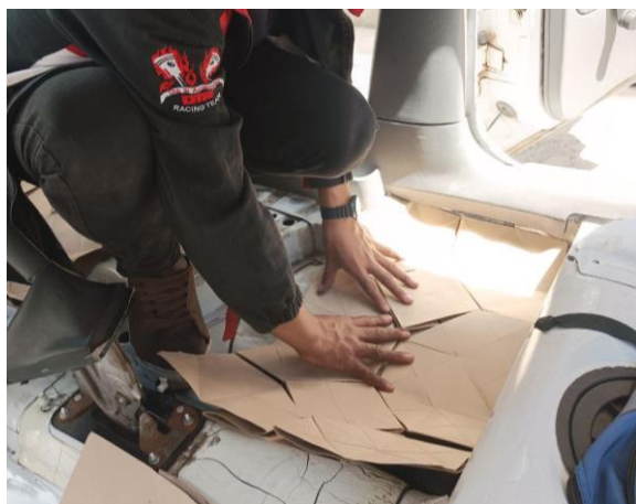
Figura 2.39. Aplicación de láminas al piso posterior.
