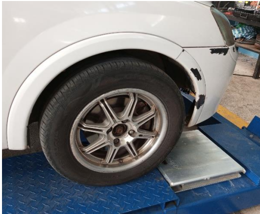
Figura 2.6. Pesaje del vehículo en el elevador.
