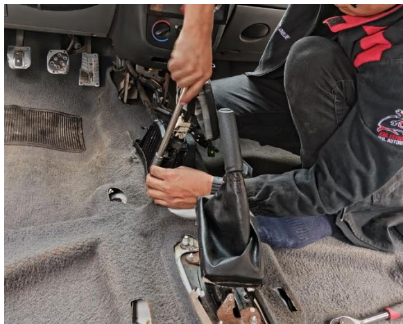
Figura 2.34. Desarmado varillaje de cambios.
