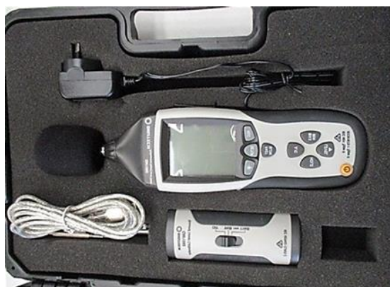
Figura 2.1. Sonómetro Digitech QM1592 y accesorios.
