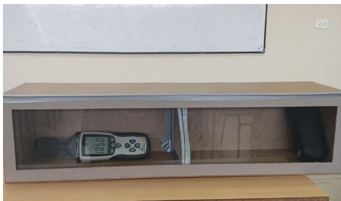
Figura 2.2. Caja sonora con fuente de ruido y sonómetro.
