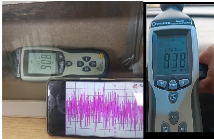
Figura 6.11. Aplicación de ruido rosa y comprobación en carretera.
