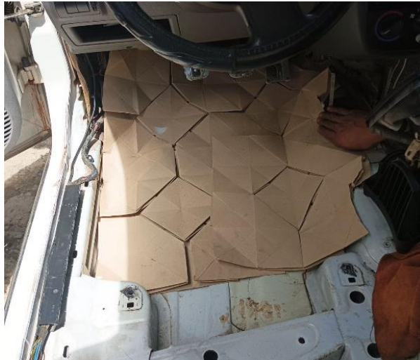
Figura 2.38. Aplicación de láminas plegadas.
