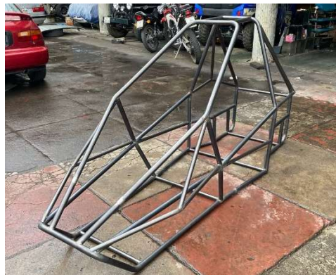
Figura 3.11 Estructura del bastidor finalizada
