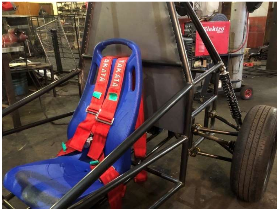
Figura 2.11 Sujeción de asiento, cinturones de seguridad y corta fuegos
