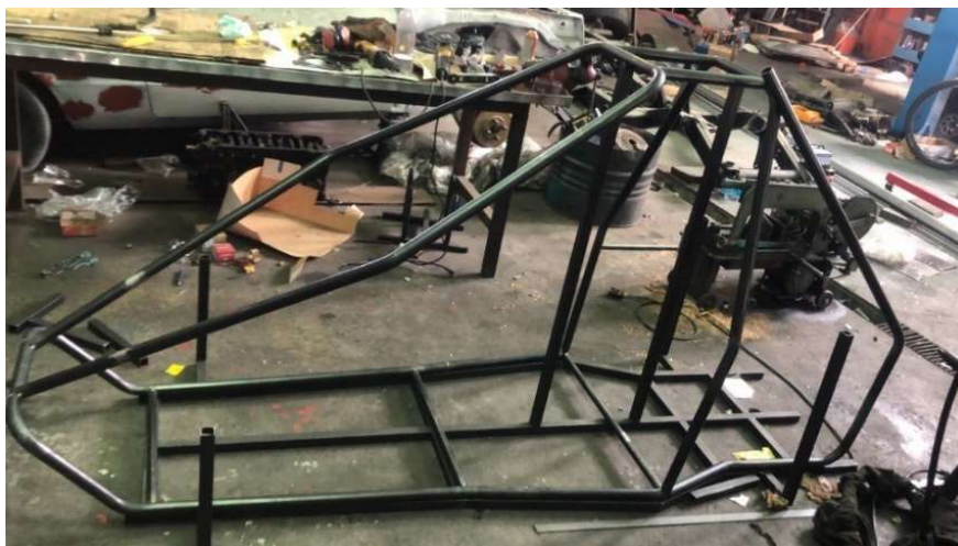
Figura 2.7 Arcos principales soldados entre si
