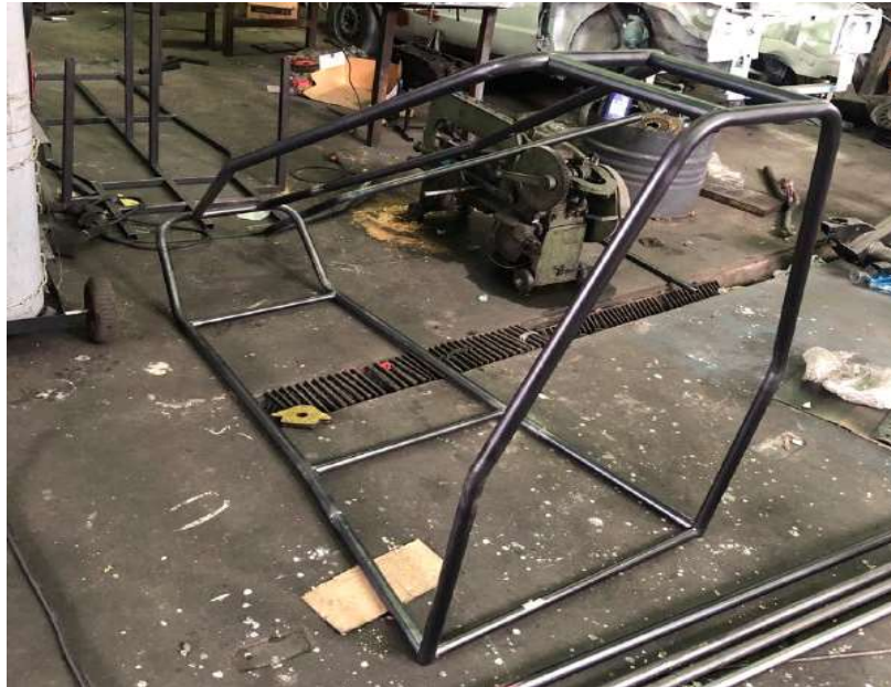
Figura 3.8 Estructura delantera conformada por los arcos principales
