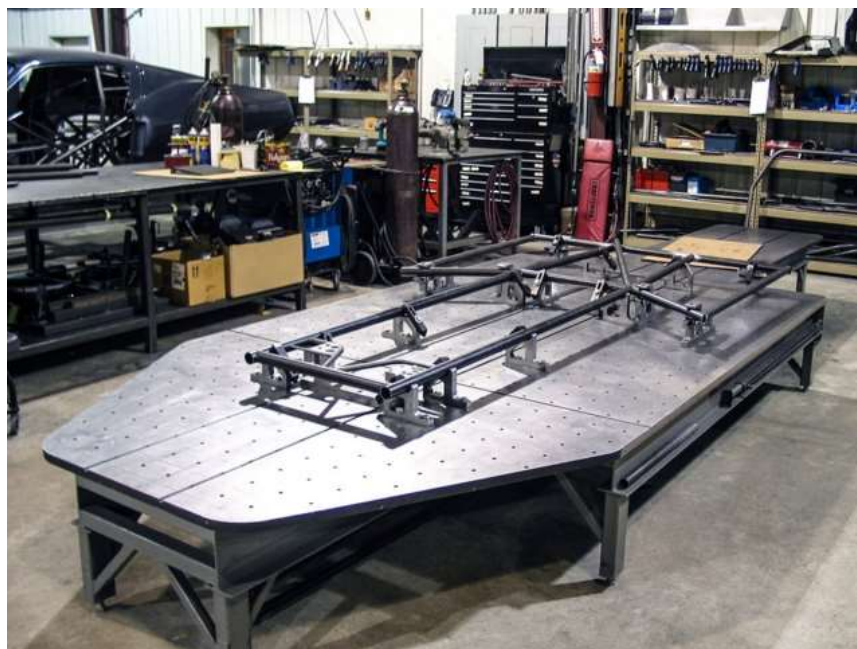
Figura 1.1 Modelo de Jig de soldadura
