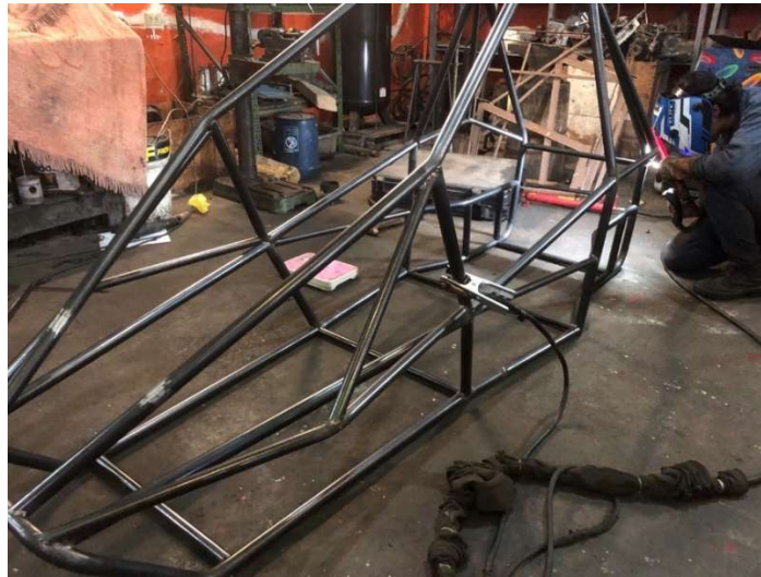
Figura 2.9 Soldadura de miembros estructurales del bastidor mediante proceso MAG
