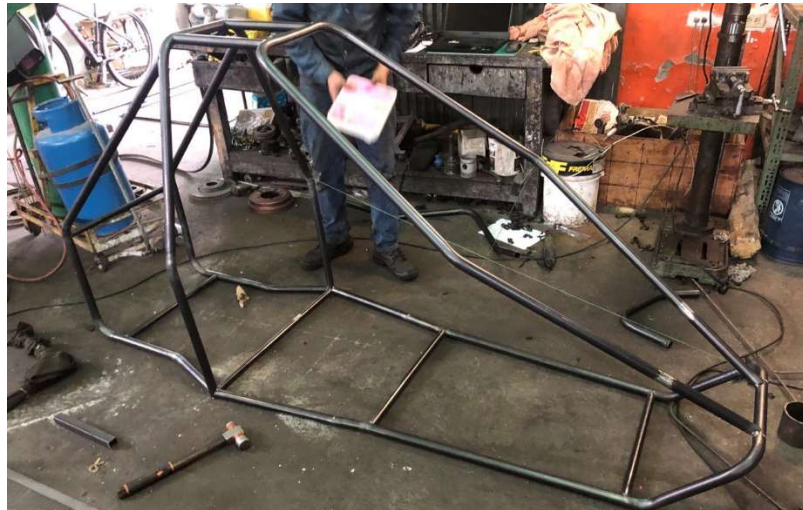
Figura 2.8 Estructura del bastidor conformada por arcos principales delanteros y traseros
