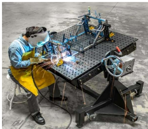
Figura 1.2 Modelo Jig de soldadura móvil
