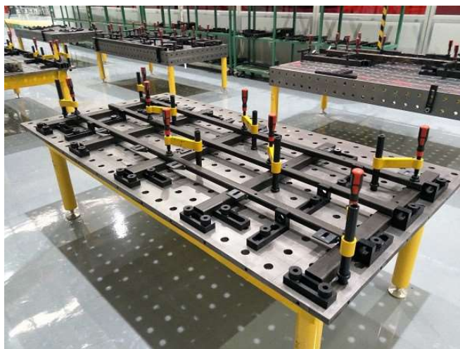
Figura 1.2 Modelo de Jig de soldadura estático
