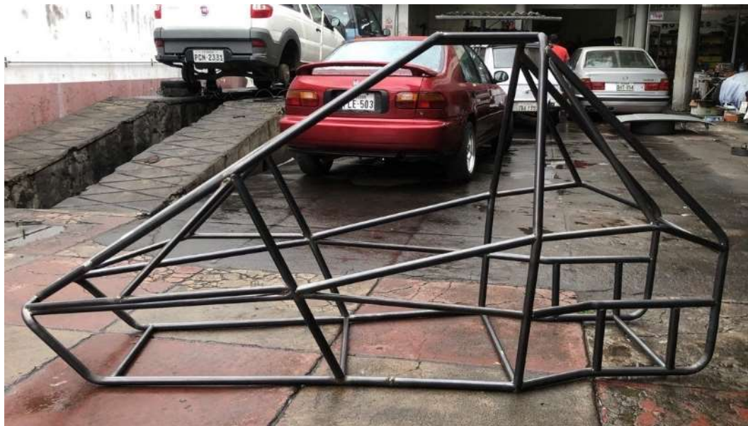
Figura 2.10 Bastidor con todos sus miembros estructurales soldados
