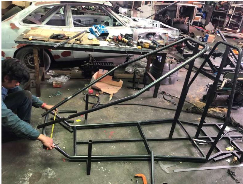
Figura 2.6 Arcos principales sobre la matriz de soldadura
