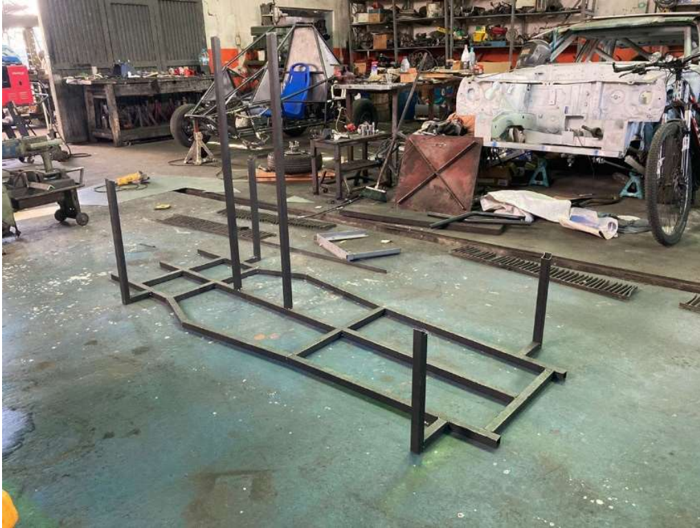
Figura 2.5 Jig de soldadura para la fabricación del bastidor
