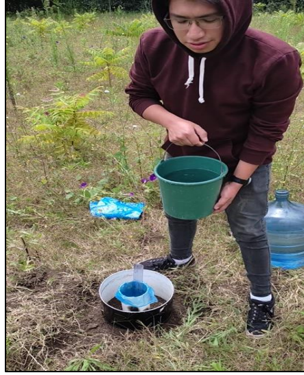
Anexo 21. Rellenado del anillo principal del infiltrómetro en el campus Yuyucocha.
