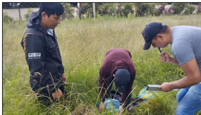
Anexo 20. Rellenado del anillo principal del infiltrómetro en el predio de la fábrica la Gardenia.
