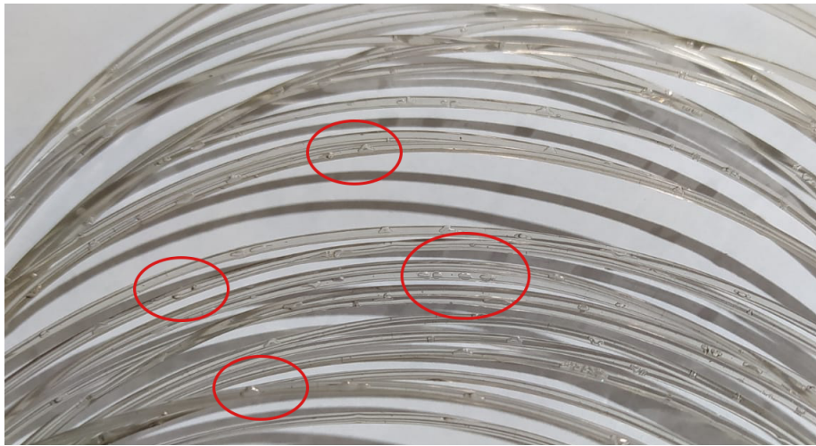
Figura 3.57: Filamento con material húmedo
