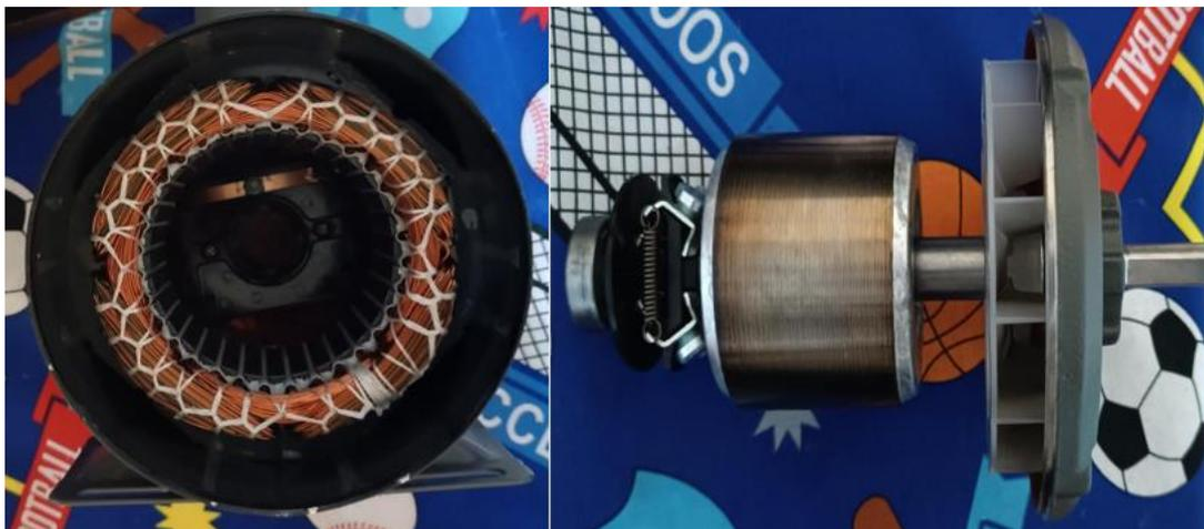
*Figura 19: Parte Interna del motor de inducción a) Estator b) Rotor
