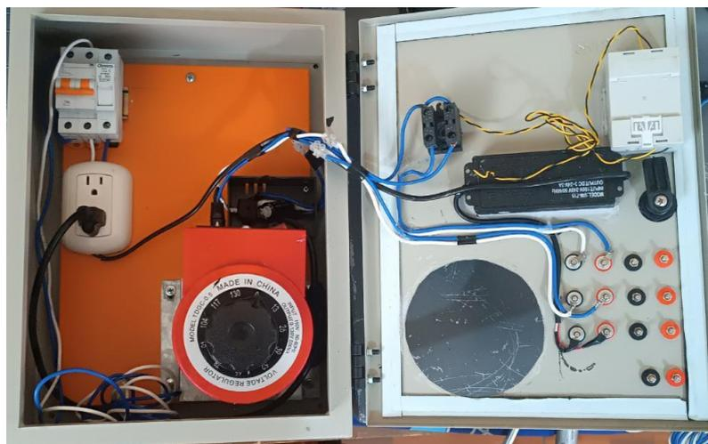
Figura 63: Conexión de las salidas de alimentación
