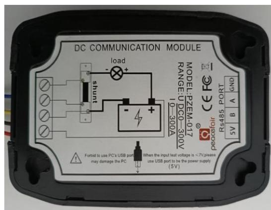
Figura 52: Diagrama de conexión del PZEM-017
