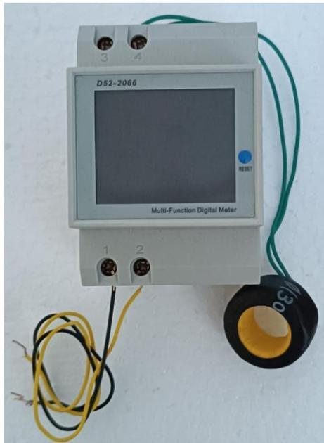
Figura 50: Medidor Digital Multi-Función D52-2066
