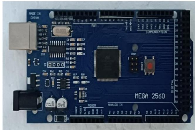
Figura 47: Placa Arduino Mega 2560
