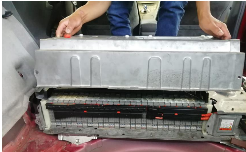
Figura 4.4 Desmontaje de la carcasa de la Batería de Alta Tensión Fuente: Elaboración propia
