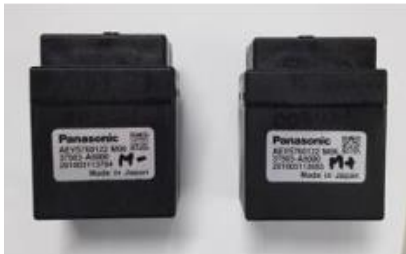
Figura 2.9 Relé principal positivo y negativo Fuente: (Hyundai, 2020)
