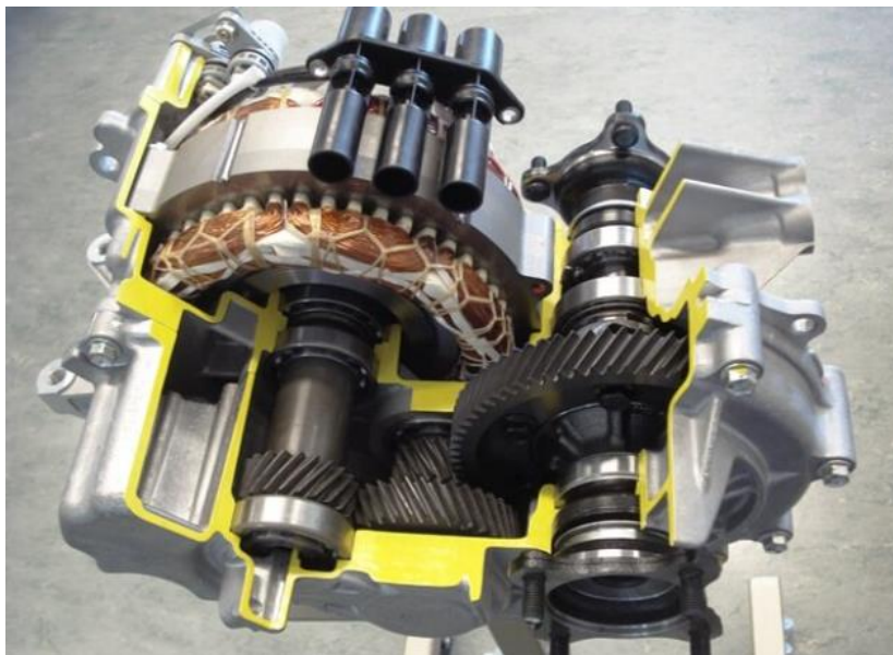
Figura 2.17 Transmisión de vehículo híbrido en corte-motor MG1
