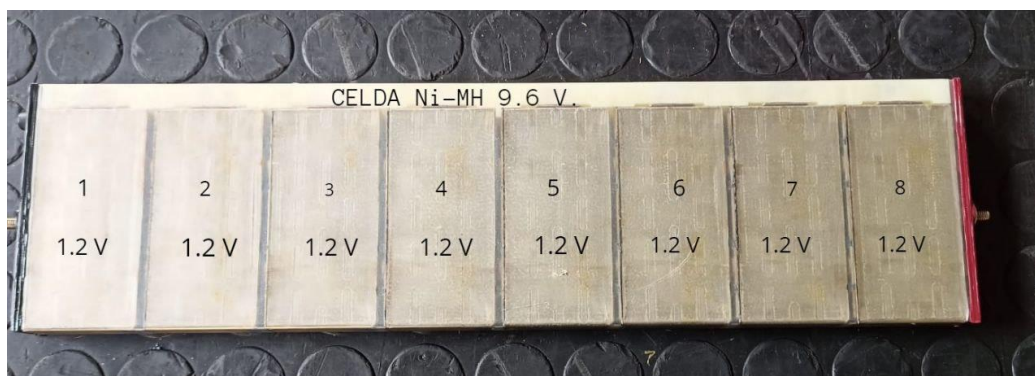
Figura 2.19 Celda de batería Toyota Highlander
