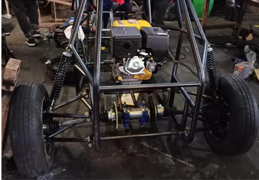
**Figura 3.21:** Adaptación de conjunto de transmisión
