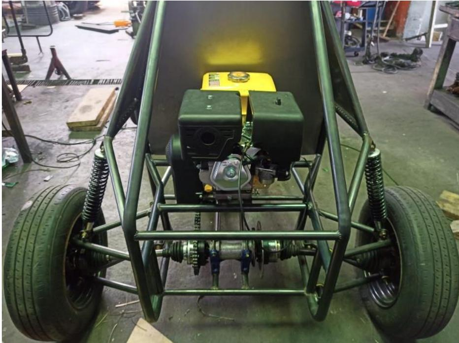
**Figura 3.27:** Tren posterior ensamblado
