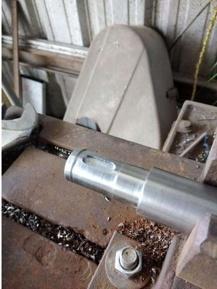
**Figura 3.15:** Proceso de fresado del eje de transmisión
