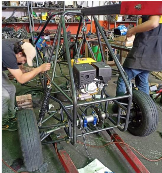
**Figura 3.22:** Adaptación de motor
