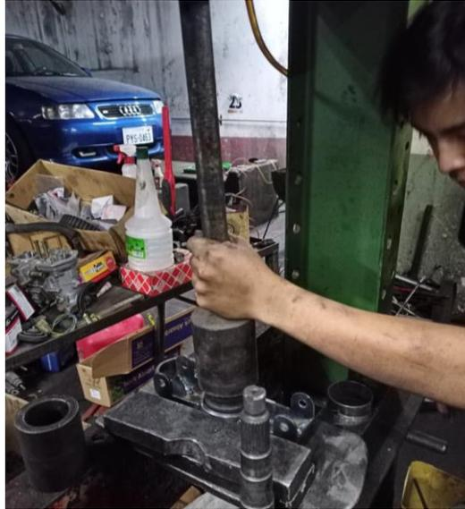
**Figura 3.23:** Compresión de rodamientos
