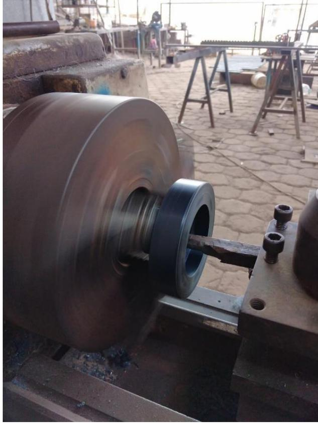
**Figura 3.14:** Proceso de torneado de las bridas
