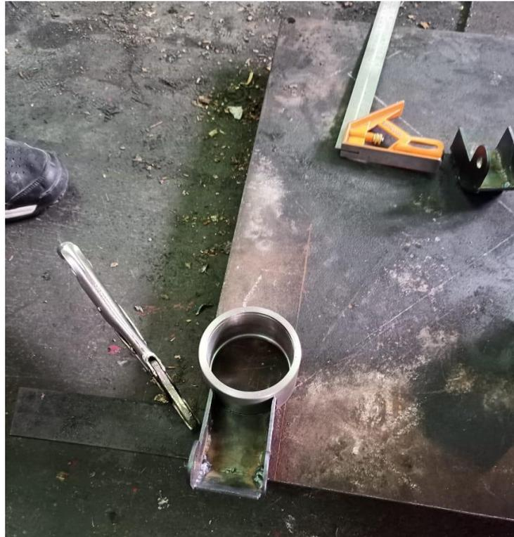
**Figura 3.20:** Proceso de soldadura de la mangueta
