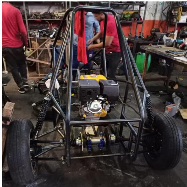
**Figura 3.26:** Ensamble parcial de tren posterior
